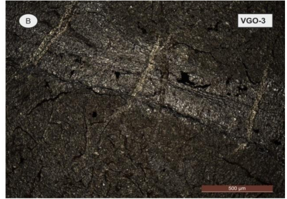
Şekil 4.3. Peridotitlerde kırık ve çatlaklarda gelişen talk minerali
