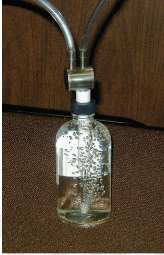
Şekil 4. 16. RAD7 aktif ölçüm cihazı, ölçümden önce hava üflenmesi aşaması
