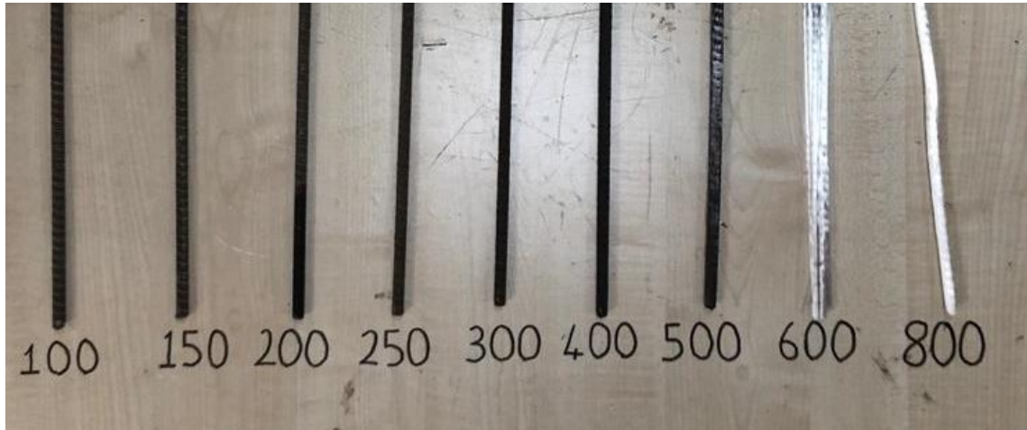
Şekil 4.9. GFRP donatıların her bir sıcaklık değerindeki görünüşleri
