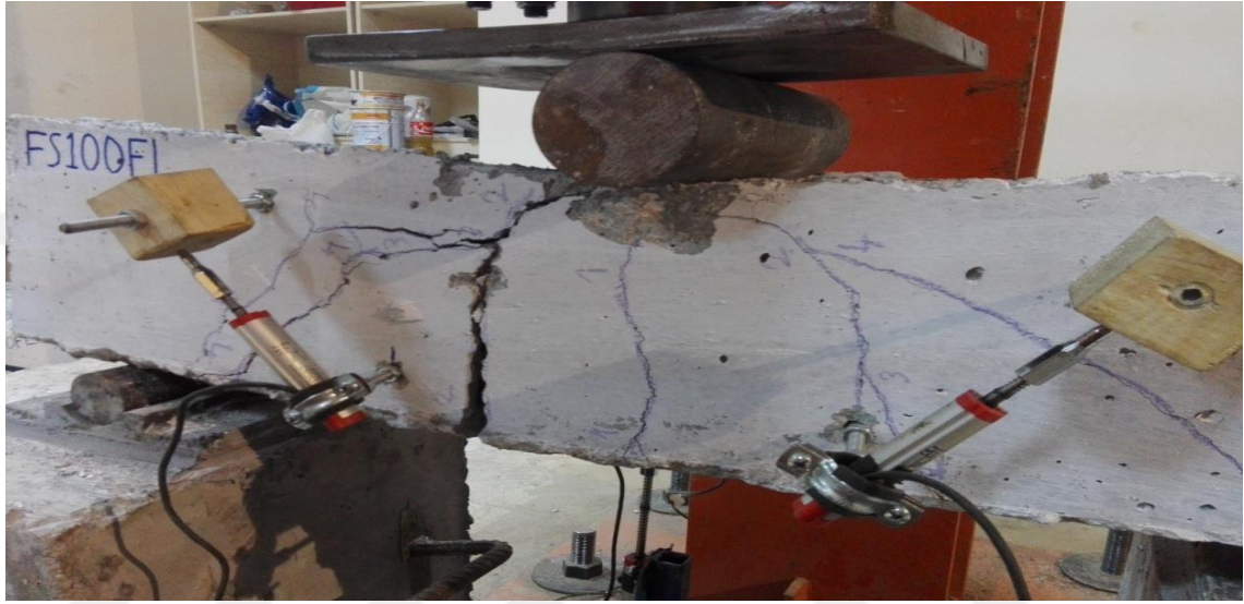
Şekil 5.10. Deney Sonunda FS100FL Kiriş Numunesi.
