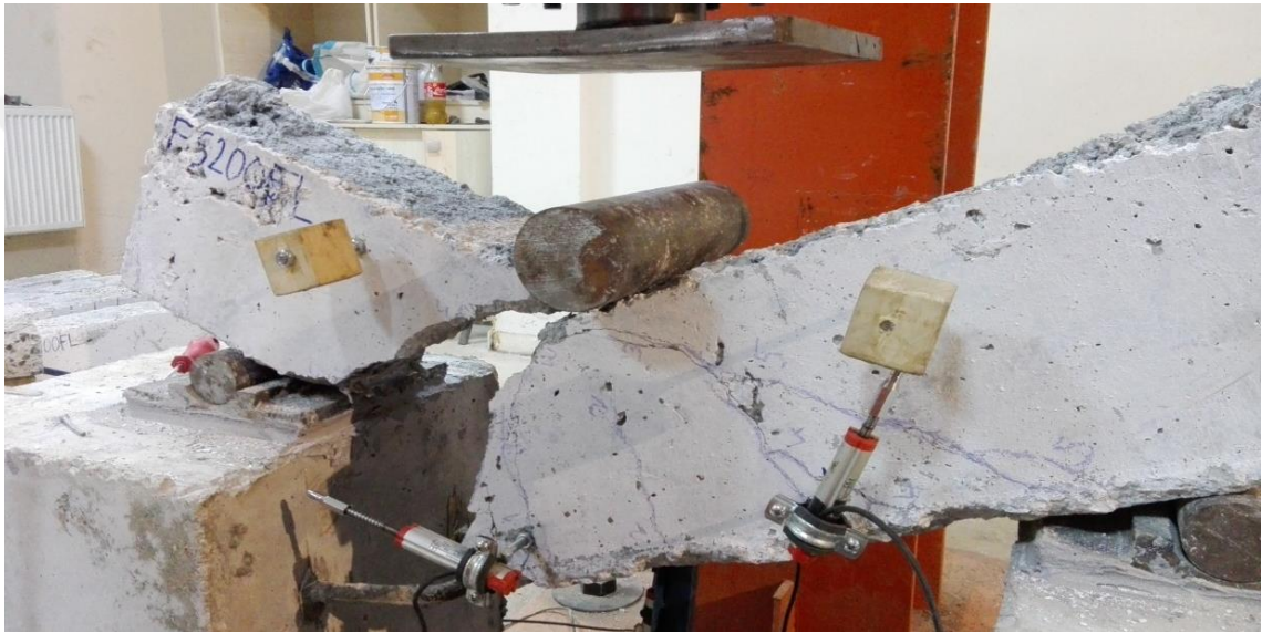
řekil 5.18. Deney Sonunda FS200FL Kiriř Numunesi
