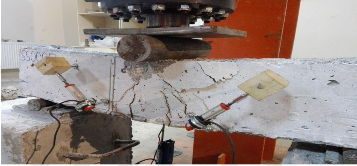
Şekil 5.2. Deney Sonunda SS000FL Kiriş Numunesi
