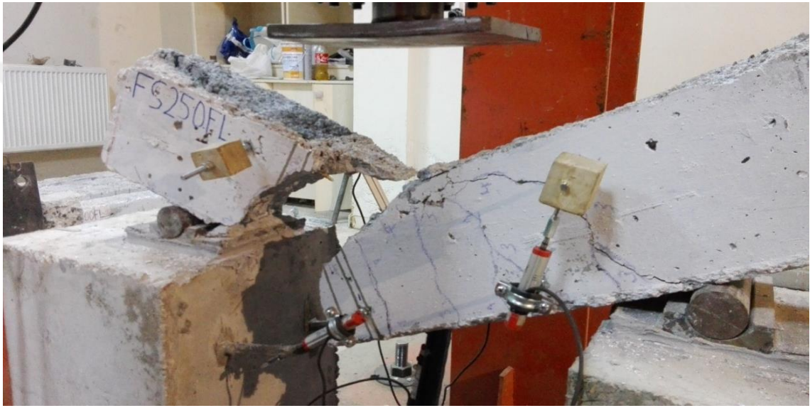
řekil 5.22. Deney Sonunda FS250FL Kiriř Numunesi
