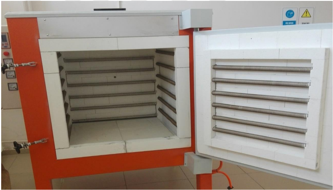
Şekil 4.7. 1200°C rejimli seramik fırını.
