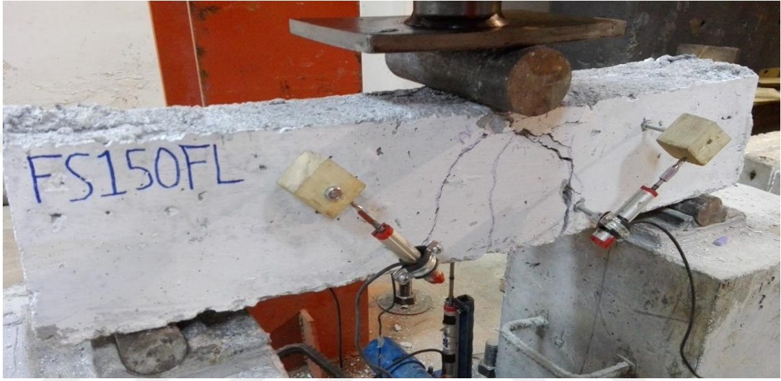
Şekil 5.14. Deney Sonunda FS150FL Kiriş Numunesi
