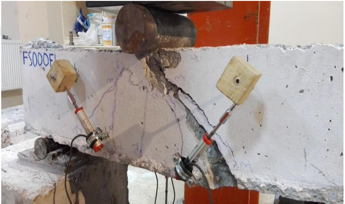
Şekil 5.6. Deney Sonunda FS000FL Kiriş Numunesi
