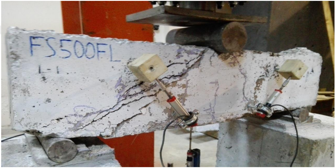
Şekil 5.34. Deney Sonunda FS500FL Kiriş Numunesi
