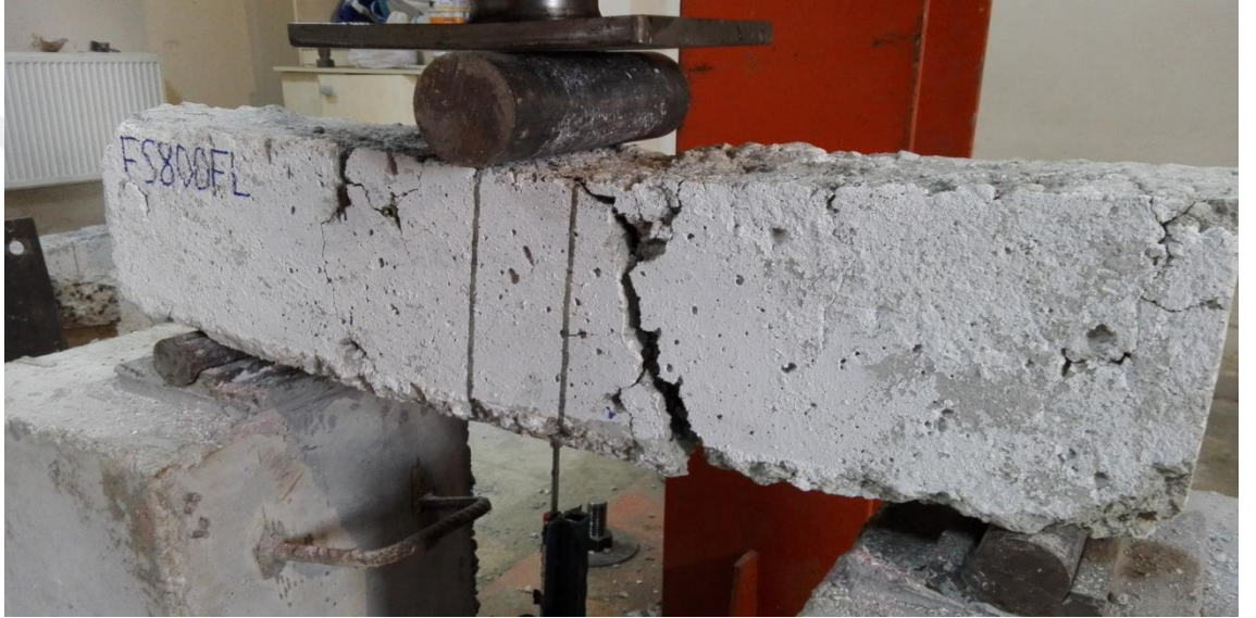
řekil 5.42. Deney Sonunda FS800FL Kiriř Numunesi
