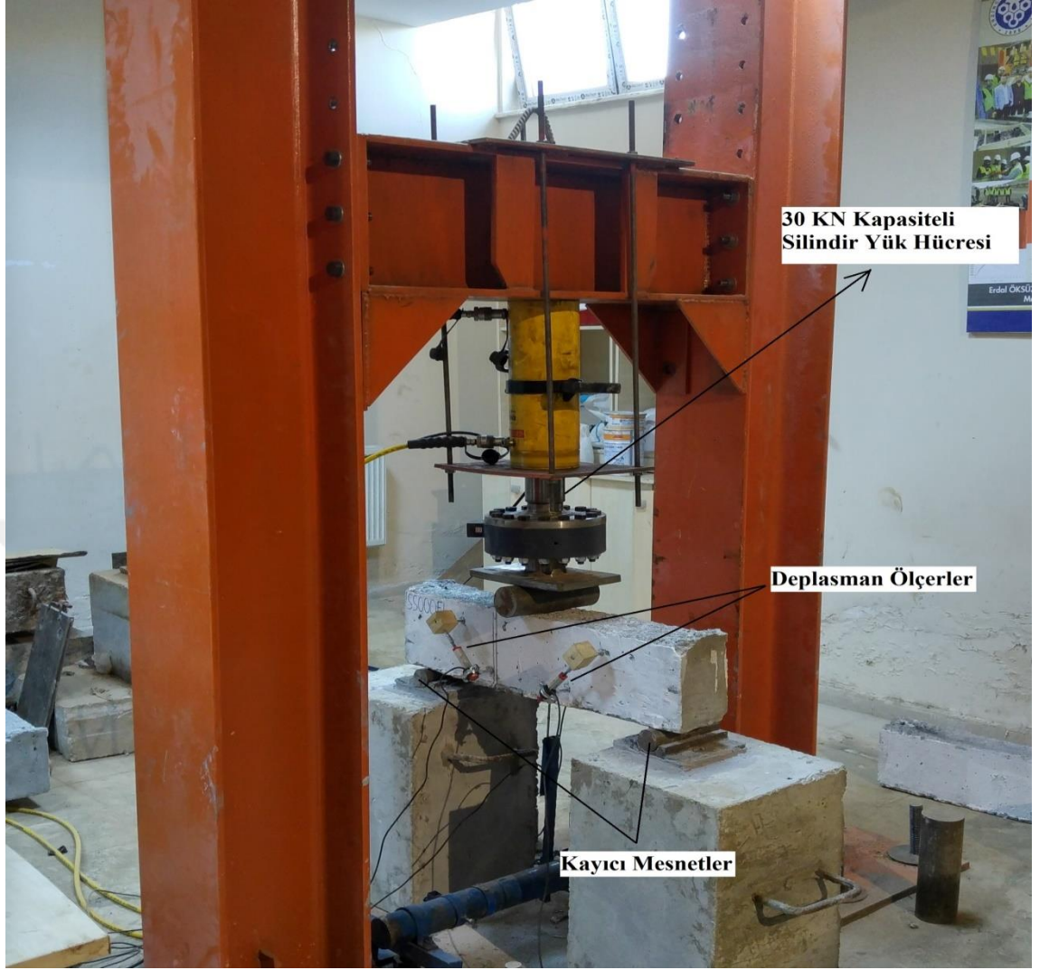
Şekil 4.18. Kiriş numuneleri için deney düzeneği
