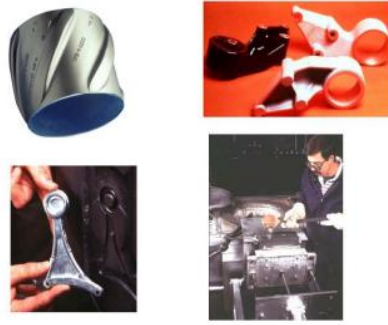
Şekil 1.2. Kokil kalıp ile üretilen parçalar (Gıyasettin E, 1979)
