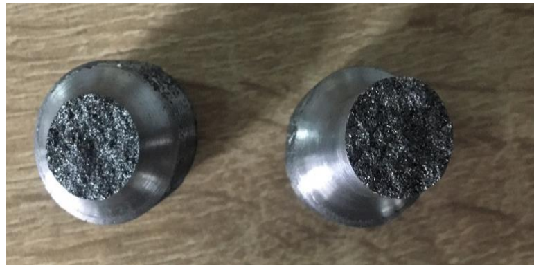
Şekil 4.26. Çekme Testi Sonrasında Porozite Kontrollü Yapılmıştır. Poroziteye Rastlanmamıştır.
