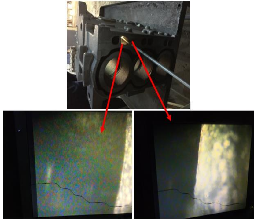
Şekil 4.40. Gözle Görülmesi Zor Olan Bölgelerin Boroskop Yardımı İle Kontrol Edilmesinin Gösterimi.
