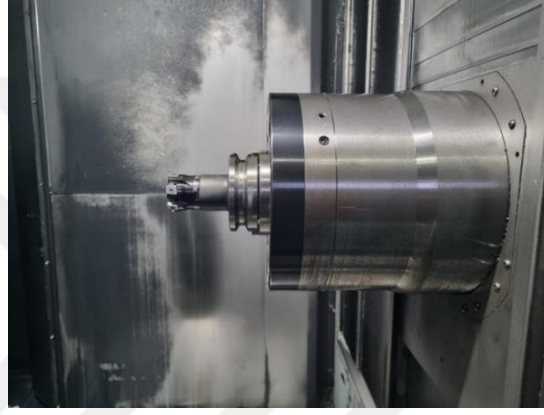
Şekil 5.7. Finaş freze takımının tezgahdaki görüntüsü.
