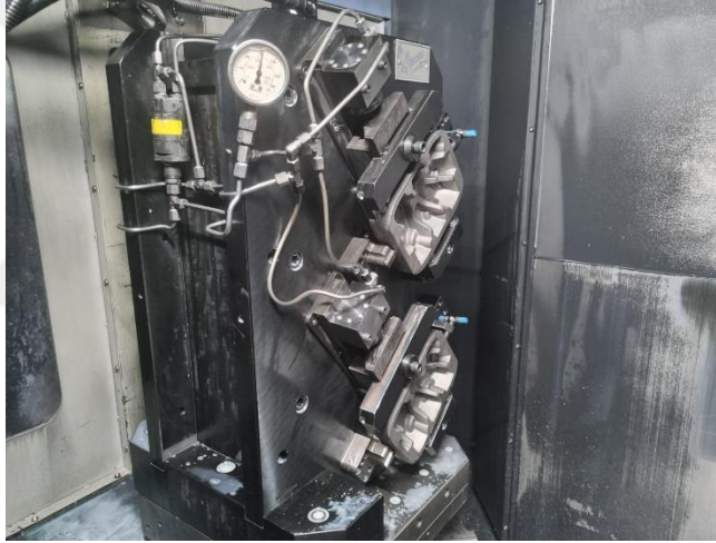
Şekil 5.2. İş parçasının fikstür üzerindeki yerleşimi.
