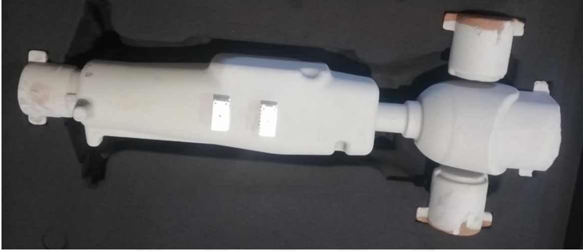
Şekil 35. Deney parçasına ait maçaların kalıp içindeki görüntüsü
