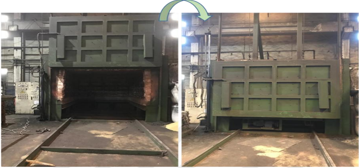
Şekil 38. Deney parçalarının tavlama ısıtılma işlemine tabii tutulduğu fırının görüntüsü
