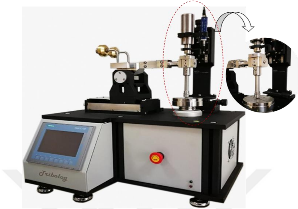
Şekil 45. Dairesel hareket esasına dayanan aşınma deney cihazının şematik görünümü
