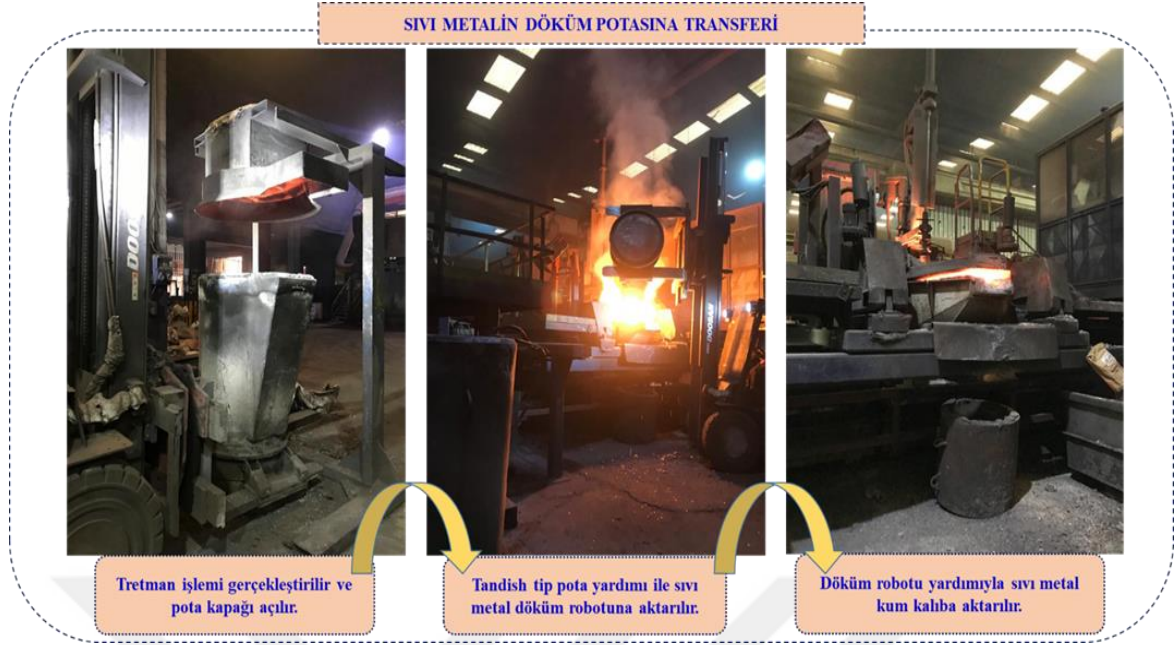
Şekil 32. Küreselleştirme işlemi tamamlanan sıvı metalin döküm robotuna aktarılması
