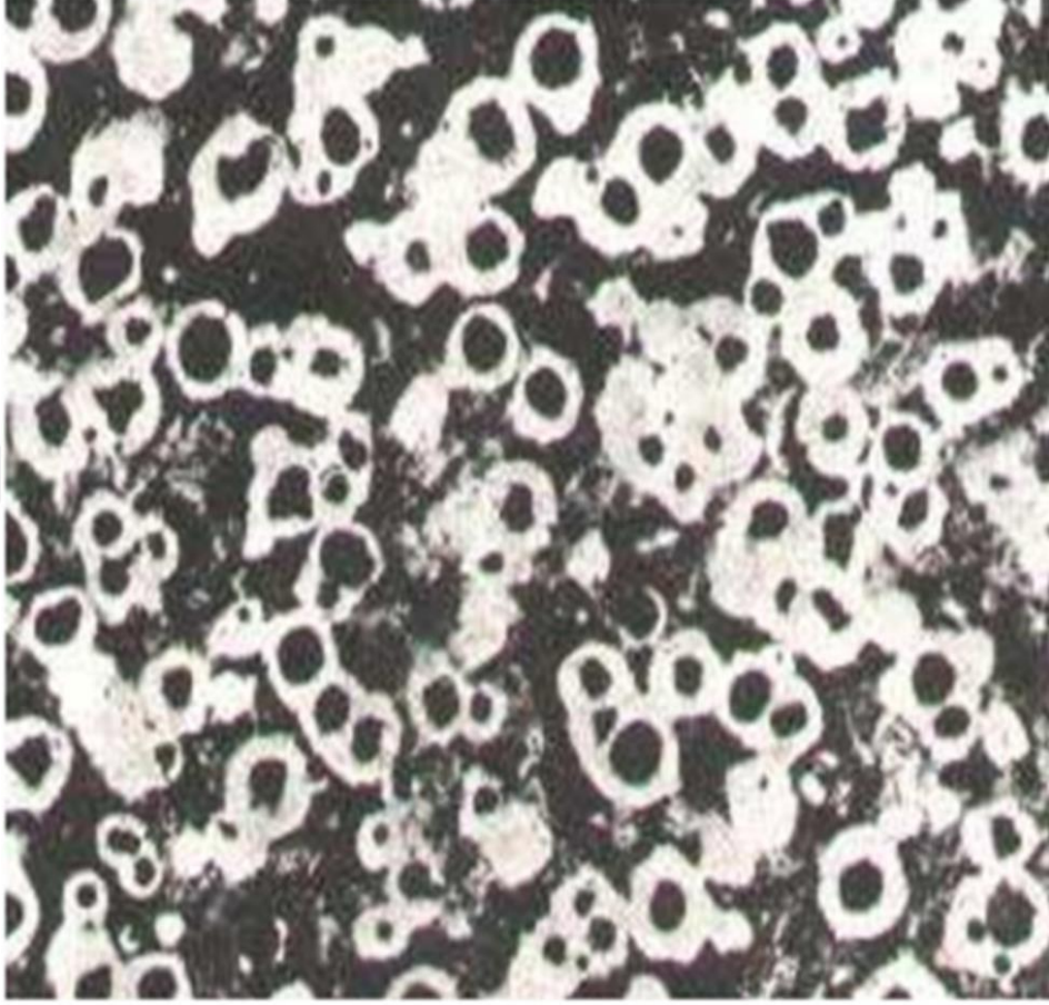
Şekil 8. PKGDD mikroyapı görüntüsü [8].
