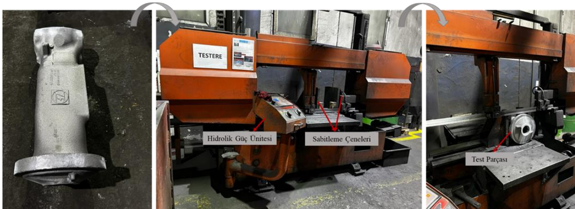
Şekil 41. Penetran sıvı testinde deney parçalarının kesildiği testere ve işlem aşamaları
