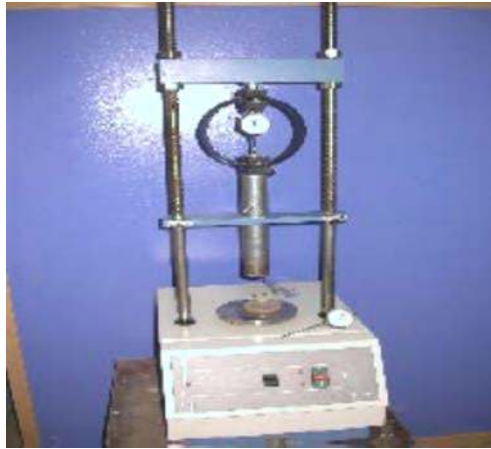
Şekil 15. Serbest basınç deney aleti
