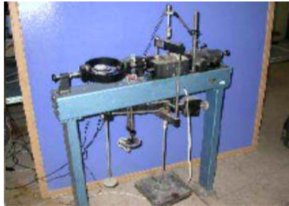
Şekil 11. Kesme kutusu deney aleti
