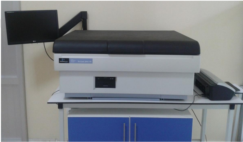
Şekil 4. Kullanılan sıvı sintilasyon sayacının görseli
