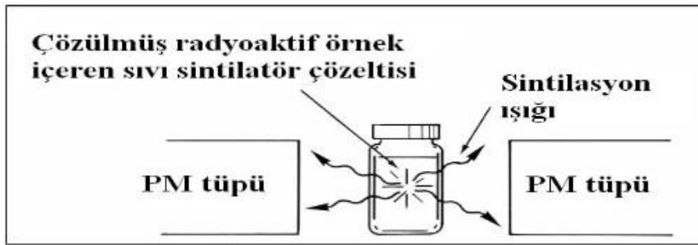
Şekil 6. Vialde bulunan örneğe ait sintilasyon mekanizması
