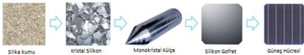
Şekil 2.1. Monokristal silikon güneş pili yapımında yer alan temel malzemeler ve adımları [3]
