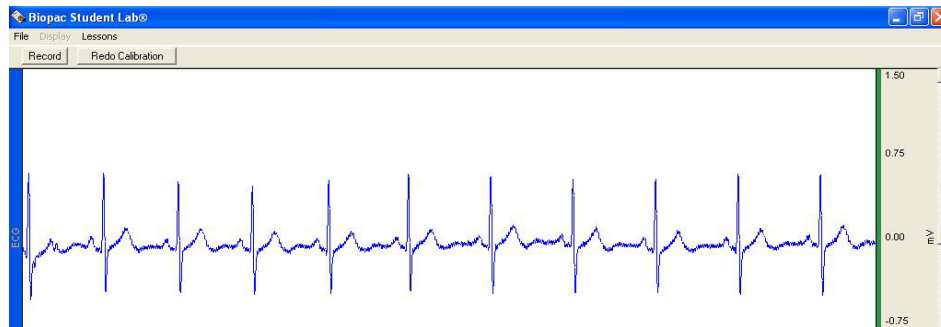
Resim 4.2. Tekstil elektrot kullanılarak Biopac deney seti donanımı ve yazılımı ile elde edilen EKG işareti
