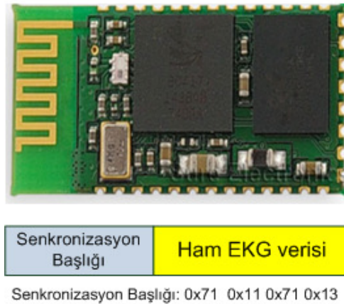
Şekil 3.9. Kullanılan bluetooth modül ve veri paketi yapısı
