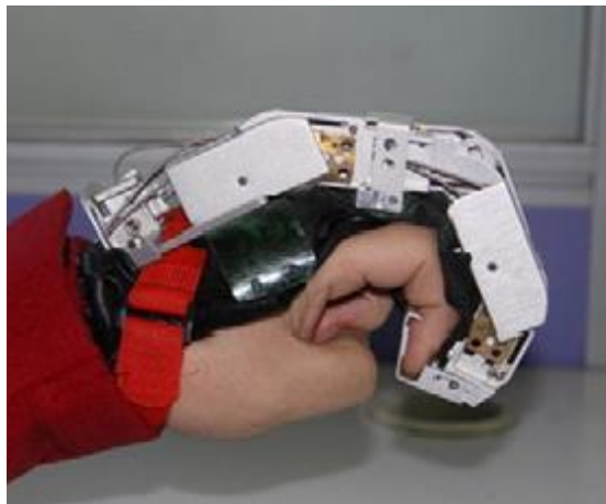
Şekil 2.7 Zhang ve arkadaşlarının el dış iskelet tasarımı (Zhang vd., 2014).
