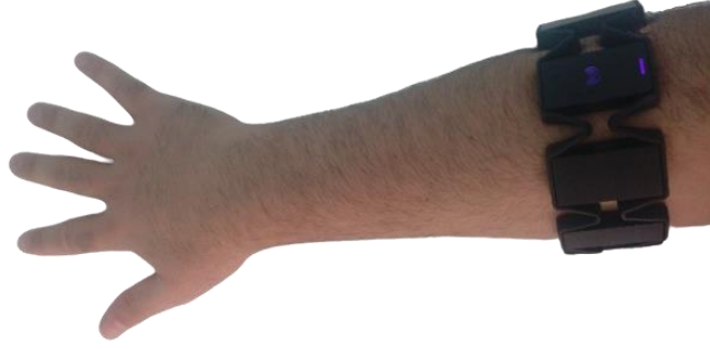
Şekil 3.15 Veri seti oluşturulurken MYO kol bandının konumu
