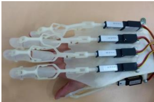
Şekil 2.17 Cui ve arkadaşlarının el dış iskelet tasarımı (Cui vd., 2010).
