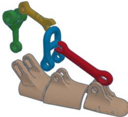
Şekil 3.3 Güç aktarma mekanizması.
