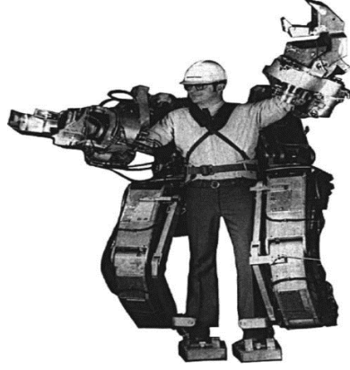
Şekil 2.1 Hardiman Dış iskeleti (Corliss ve Johnsen, 1968).
