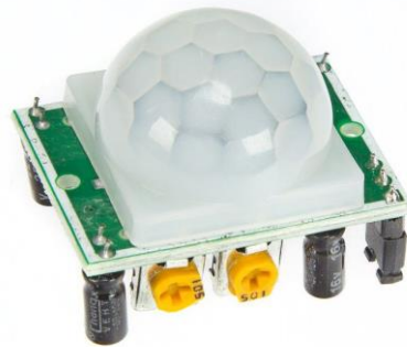
Şekil 2.3 HC-SR501 PIR Sensörü [32]
