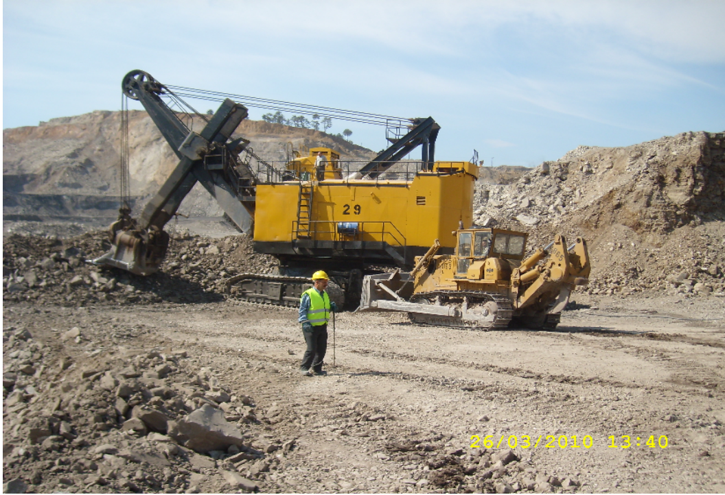
Şekil 8.6. Elektrikli Ekskavatörün yanındaki dozer
