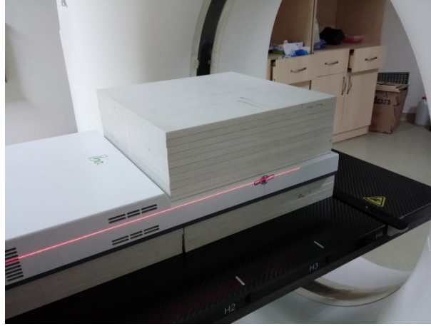
Resim 3.17. I'mRT matriXX dedektörü BT taraması
