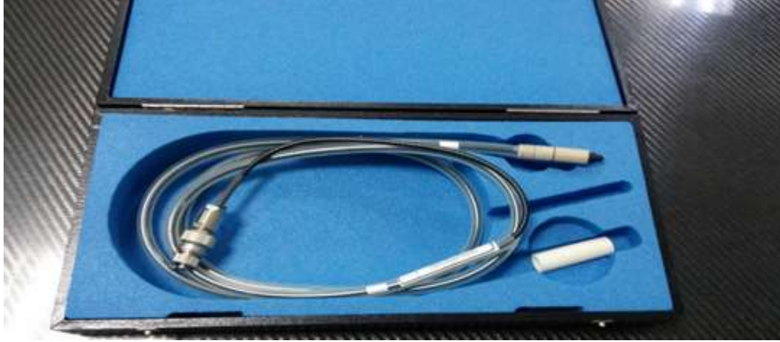
Resim 3.9. İba marka CC04 iyon odası
