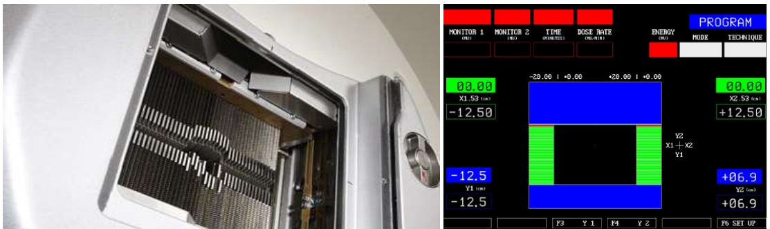
Resim 3.5. Siemens ARTISTE lineer hızlandırıcı cihazının MLC sistemi
