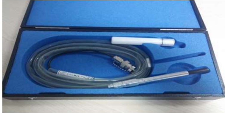
Resim 3.8. İba marka 0.65 cc farmer tipi iyon odası
