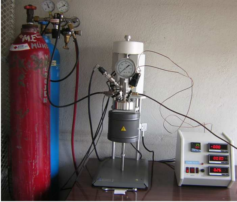
Resim 4.1. Otoklav deney sistemi
