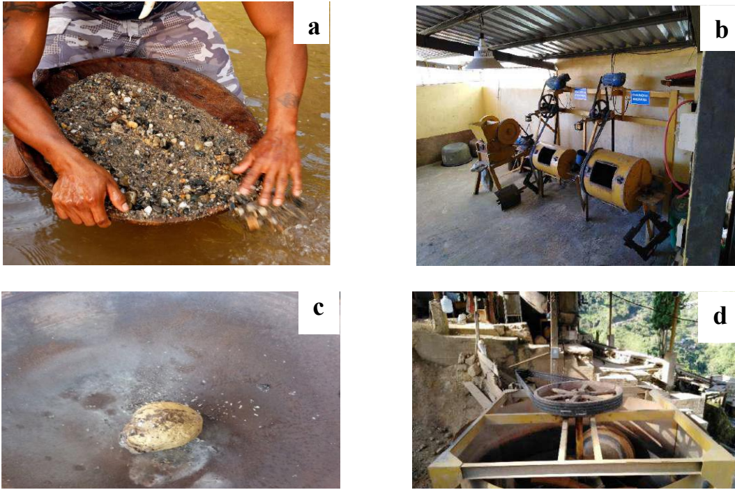
Şekil 3. ASGM Altın üretimi a) altın eleme tavası b) değirmen(Chancha) c) Sünger altın(cıva buharlaştırma sonrası kalan altın d) çarklı değirmen(şili değirmen) (MAAE, Ecuador, & MCIC, 2020)
