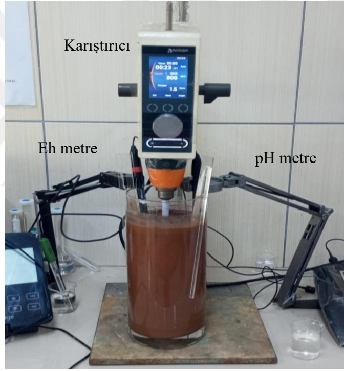
Şekil 12. Glisin liçi deney düzeneği
