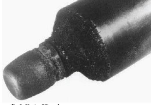
Şekil 1. Kavitasyon sonucu aşınma
