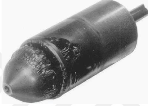
Şekil 2. Ani buharlaşma kaynaklı aşınma
