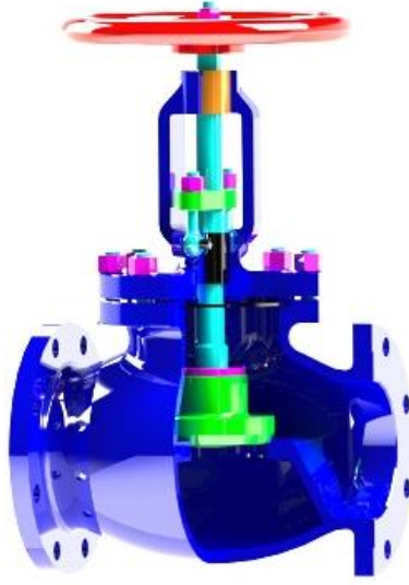
Şekil 3. Glob valf 3D tasarım kesiti gösterimi
