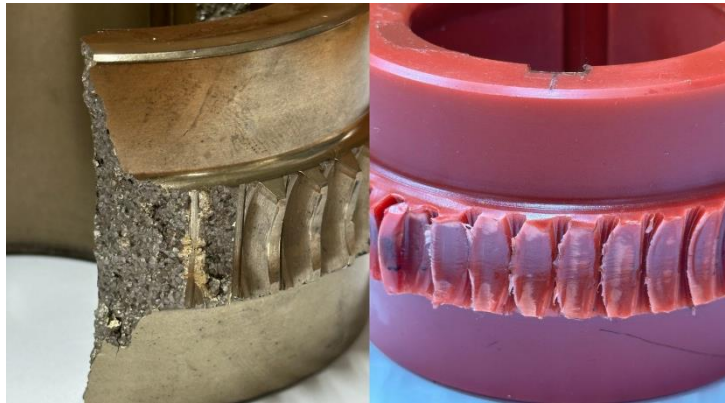
Şekil 5.15. Globoid dişli formlarının kırılma yapıları
