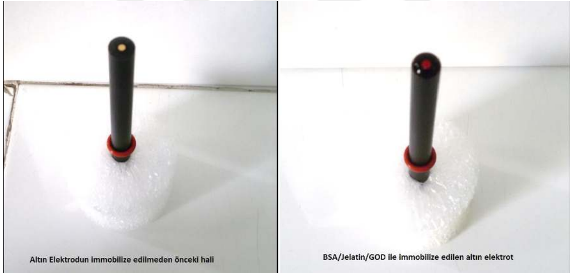
Şekil 3.1. Au elektrotun immobilize edilmeden önce ve sonraki hali.
