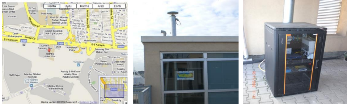
Şekil 3.3 ISTN istasyonu konum, anten ve alıcı resimleri.
