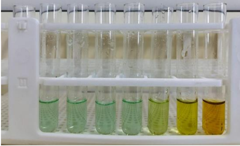
Fotoğraf 2.9 İki mM Askorbik asitin seri sulandırılmasıyla hazırlanmış CUPRAC standartları
