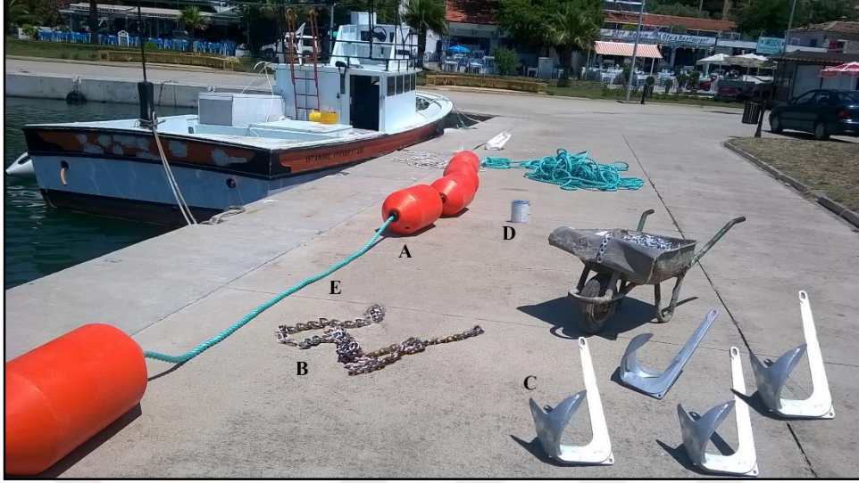
Şekil 3.2: Kara midye kültür sistemi; A) Şamandıra, B) Galvaniz zincir, C) Kurşun çapalar, D) Polietilen bağlantı ipi, E) Polipropilen halat (Orijinal).
