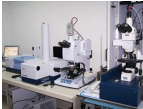
Resim 3.6 Raman Analizinin Yapıldığı Bruker IFS 66/S, FRA 106/S, Hyperion 1000, Ramanscope II marka mikroskop (İntn Kyn. 6).
