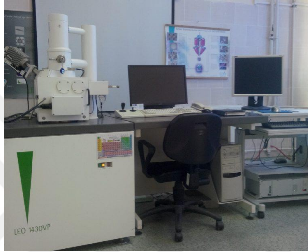
Resim 3.5 LEO 1430 VP model SEM cihazı.
