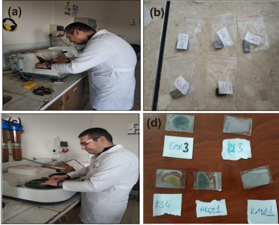
Resim 3.2 İnce kesit hazırlama aşamaları (a) İnce kesit makinesi, (b) Küçültülmüş kayaç örnekleri, (c) Taşlama Makinesi, (d) Hazırlanan ince kesit örnekleri.
