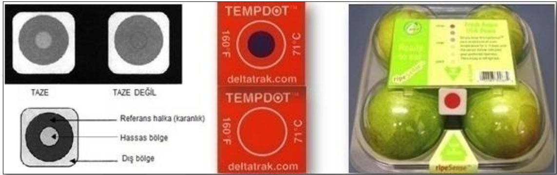
Şekil 2.10. Sıcaklık - zaman indikatör örneği ve çalışma prensibi (Anonim, 2013i).
