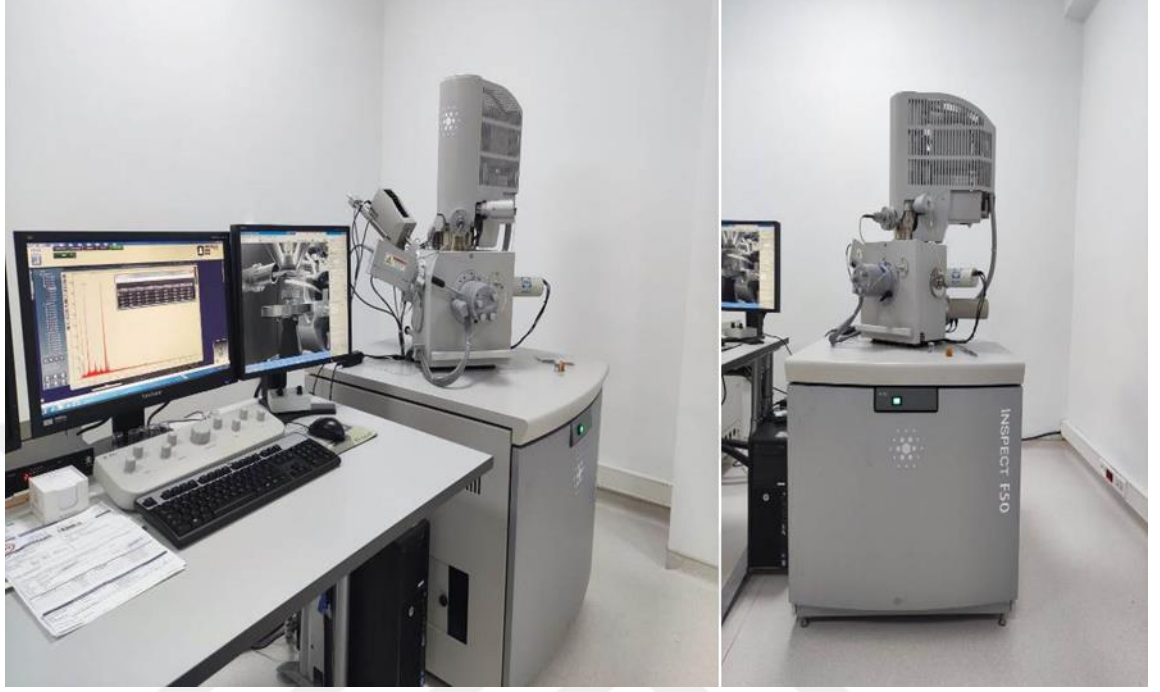
Şekil 5. MTA laboratuvarlarında SEM analiz çalışmalarında kullanılan cihaz
