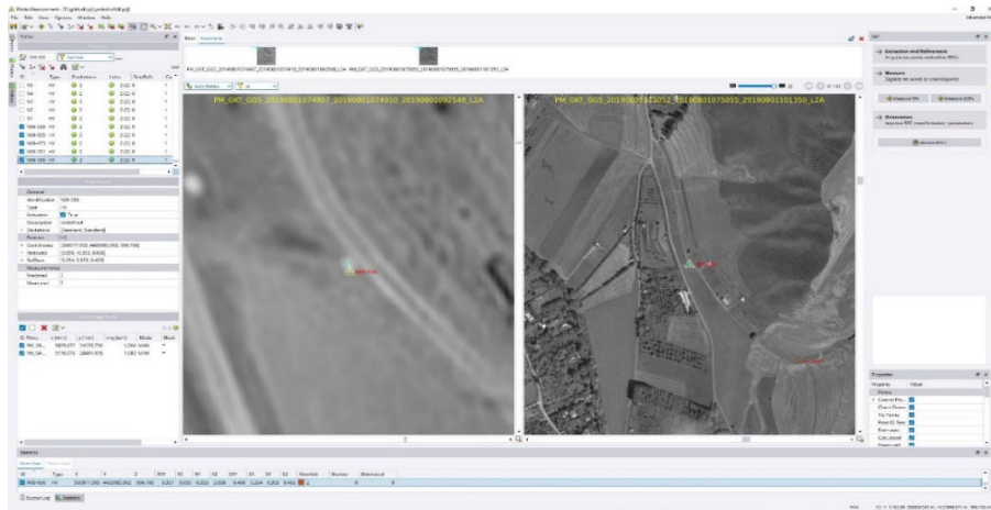
Şekil 4.5 YKN ile uydu görüntüsünü iç yönelme sonrası dengeleme işlemi.
