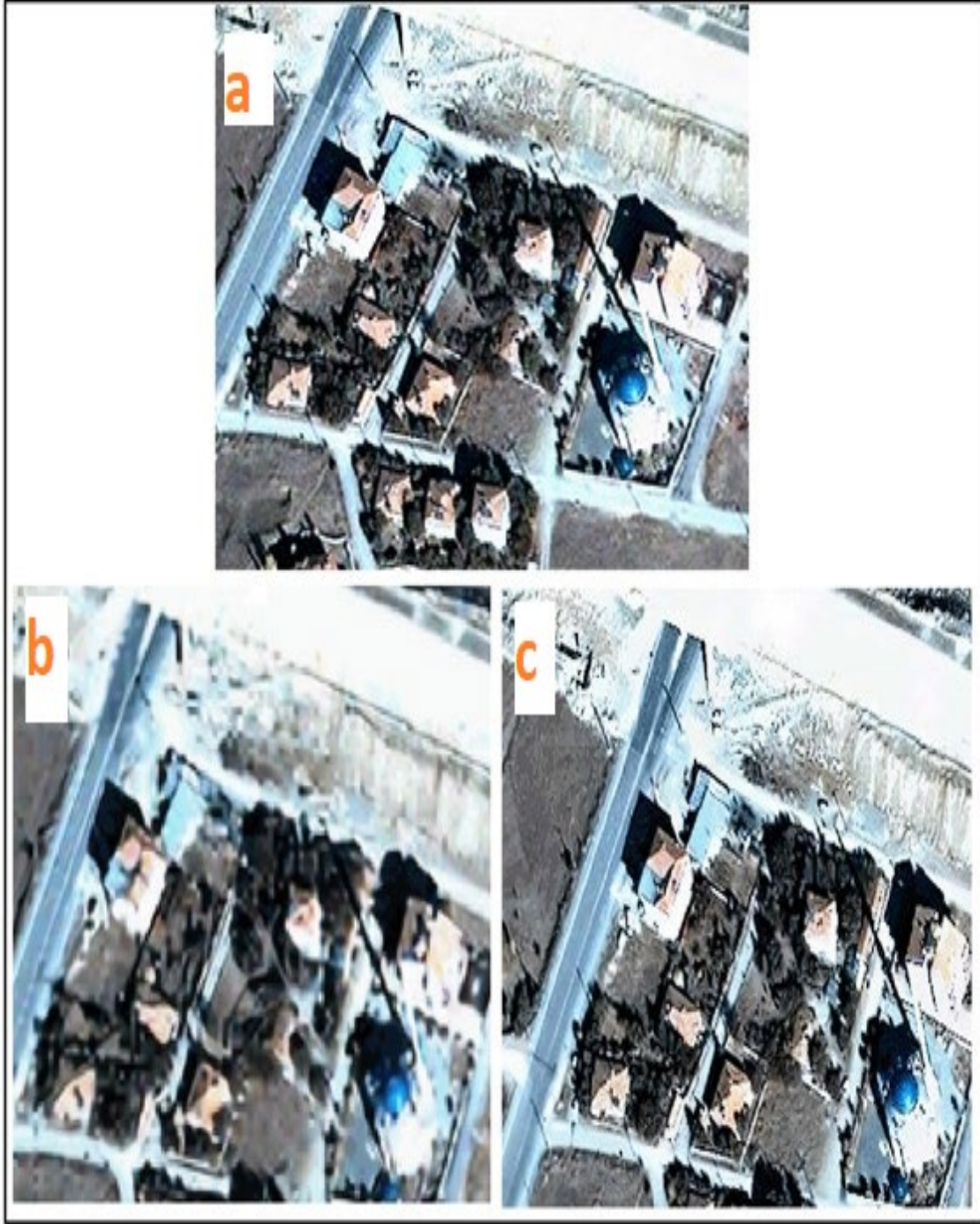
Şekil 4.35 (a) Pankeskinleştirilmiş görüntü, (b) EDSR modeli ile yapılmış SR ve (c) Topaz Gigapixel AI ile yapılmış SR.
