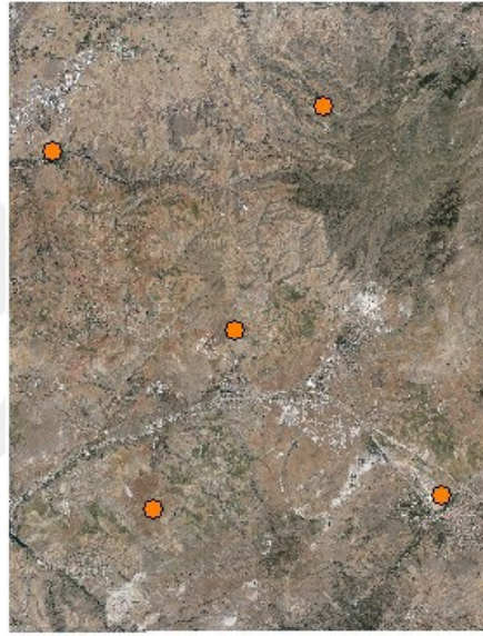
Şekil 5.1 Dengeleme işlemi için YKN dağılımı.
