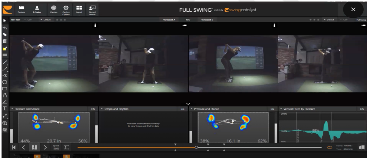
Fotoğraf 1.5 Fullswing simülasyon cihazının, hareket sırasında görüntüleme özelliği ve ağırlık transfer analizi özelliği
