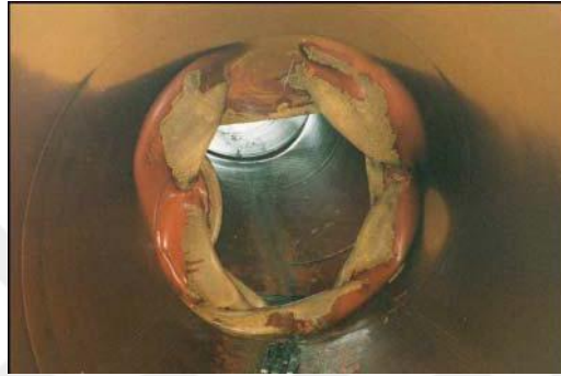
Şekil 4.3. Fay hareketi sonucunda boruda meydana gelen buruşma
