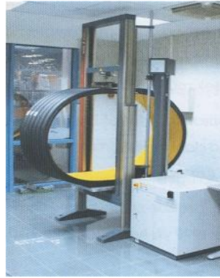
Şekil 2.1. Esnek borunun yük altındaki davranışı
