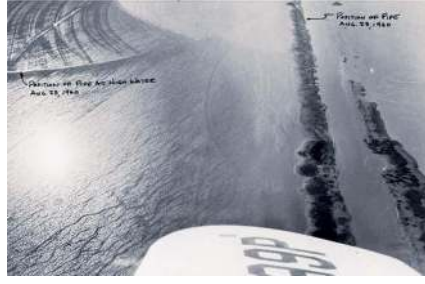
Şekil 4.5. Sıvılaşma sonucu borunun zemin yüzeyine çıkması
