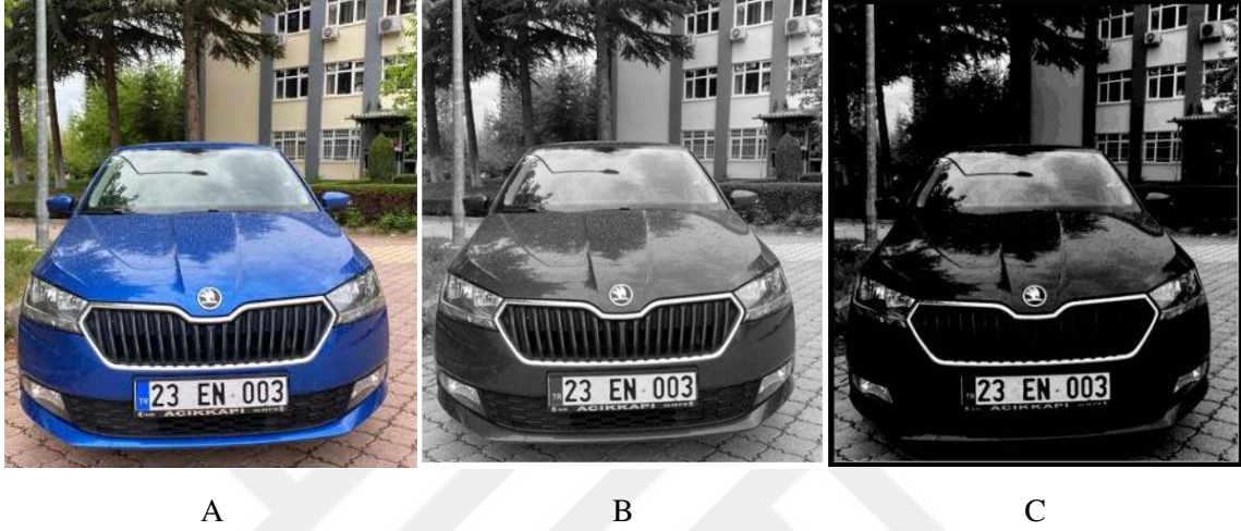
Şekil 6.3. (A) Araç rekli görüntü, (B) gri tonlamalı görüntü ve (C) MVSR normalizasyonun uygulanması
