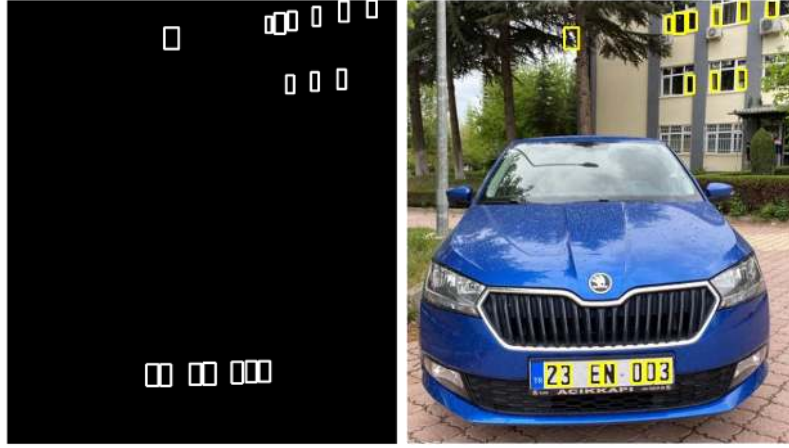
Şekil 6.6. Plaka bölgesi olabilecek yerlerin tespiti ve orijinal görüntü üzerinde gösterilmesi
