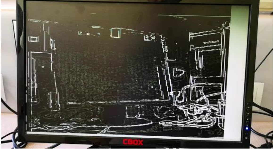
Şekil 4.47. FPGA Sobel kenar algılama VGA monitör görüntüsü
