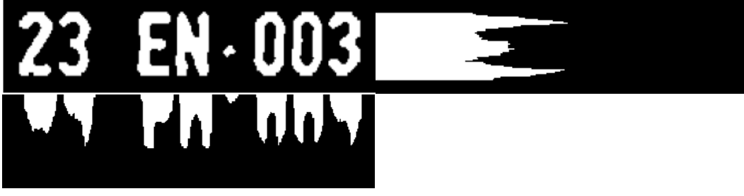
Şekil 6.11. Plaka bölgesi yatay ve dikey yansıtma tekniği
