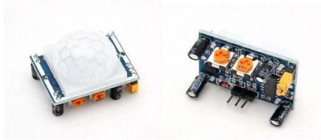
Şekil 3.35 PIR Sensörü Ön ve Arka Yüzü.
