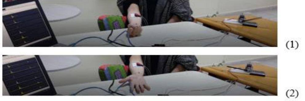
Şekil 5.9. Sistem çalışma mekanizması; el kapama/çalışma(1), el açma/durma(2)
