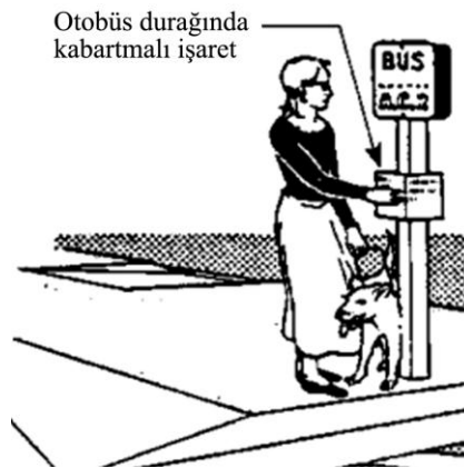
Şekil 3.23 Otobüs durağında kabartmalı işaretleme (UFAS, 1991'den düzenlenmiştir.)
