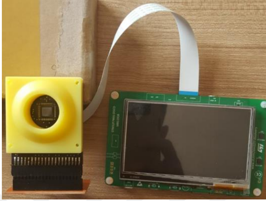
Şekil 3.24. Kamera modülü ve STM32F746 ön yüz
