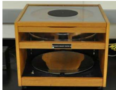
Şekil 1.1 Cusick dökümlülük ölçeri
