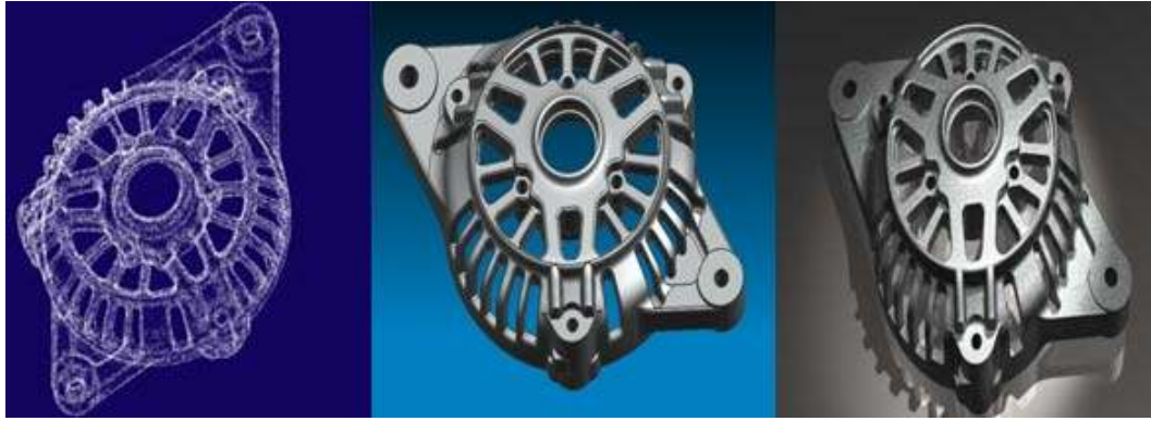
Şekil 2.50 Nokta bulutu olarak taranmış jant kapağının 3D CAD modelinin oluşturulması [15]
