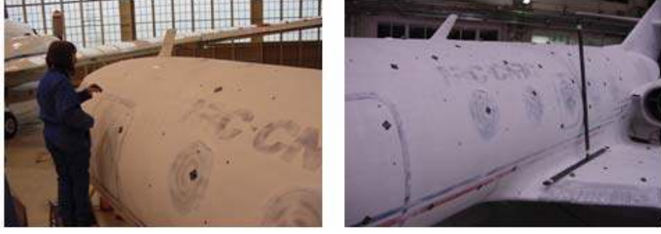
Şekil 2.38 Uçak tasarımında tarama yapılacak bölgelerin belirlenmesi [19]
