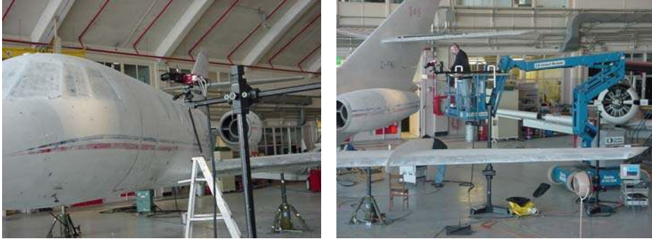
Şekil 2.39 Uçağın kameralı tarama sistemleriyle taranması [19]
