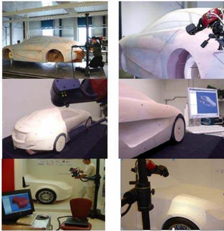
Şekil 2.37 Otomobil tasarımında kameralı tarama adımları [16]
