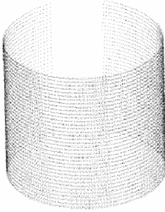
Şekil 3.18 Silindirik nesnenin 5 görüşümlü verisinin bileşimi (Yang vd.,1995)
