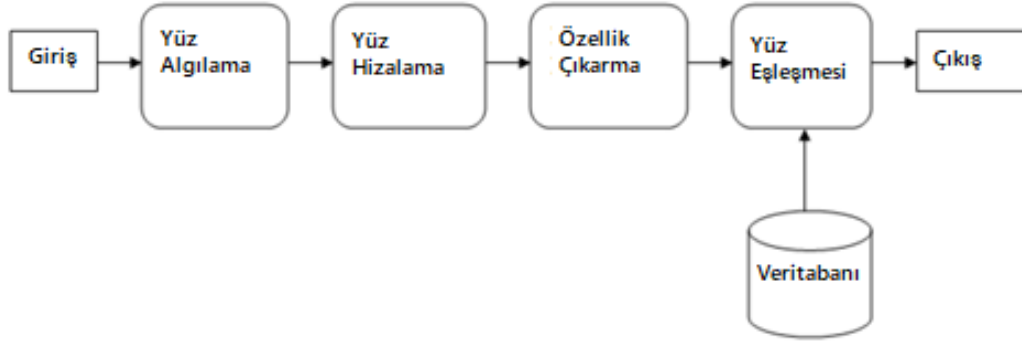
Şekil 3.9. Yüz tanıma sisteminin akış şeması
