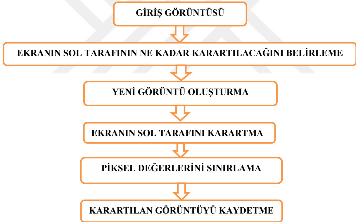
Şekil 3.17 Ekranın sol tarafının karartılması yönteminin algoritması.
