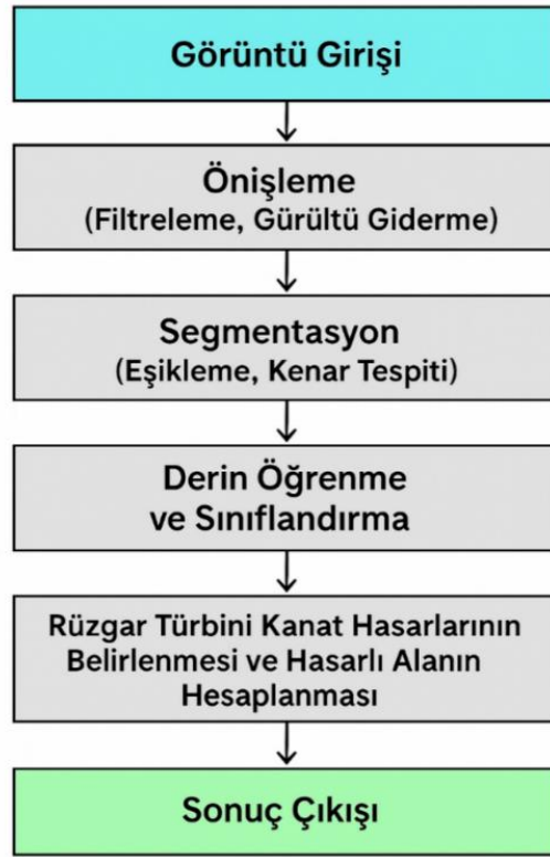
Şekil 3.1 Rüzgar türbini kanatlarındaki hasar tespiti için kullanılan algoritma.
