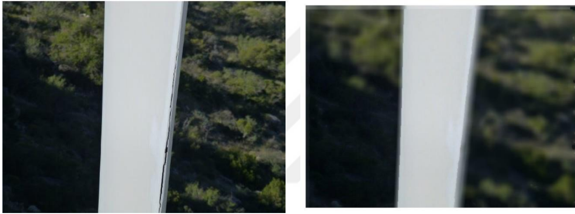
Şekil 3.3 Yumuşatma filtresi uygulanmış arka kenar çatlaması [6].
