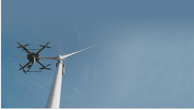
Şekil 1.1 Rüzgar türbininin drone ile izlenmesi [2].
