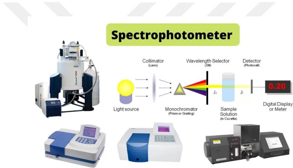
Şekil 3.2. Spektrofotometre Çalışma Prensibi
