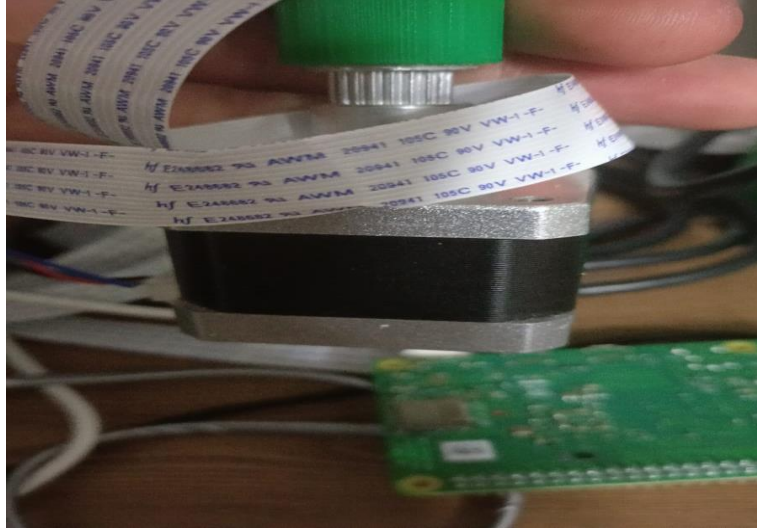
Şekil 4.11. Nema17 step(adım) motora sahip kamera
