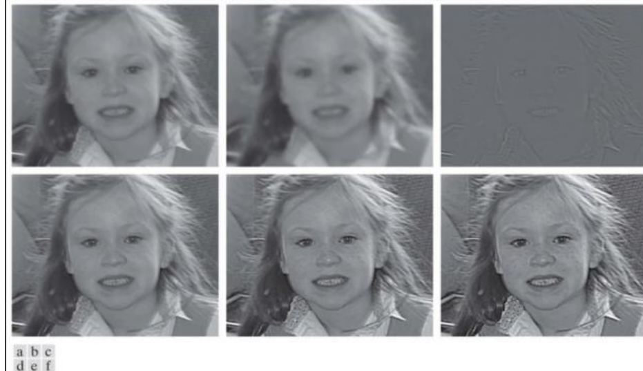
Şekil 5.14 Orjinal fotoğraf a; b, gauss kerneli ile bulanıklaştırılmış fotoğraf; c, maske; d,e,f sırasıyla k=1, k=2, k=3 için kullanılan maske ile elde edilen fotoğraflar (Gonzalez, 2008)
