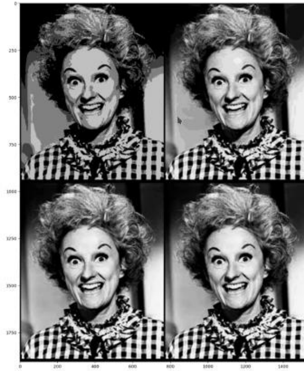
Şekil 4.15 Dört bit düzleminde oluşan bir fotoğraf (Gonzalez, 2008)
