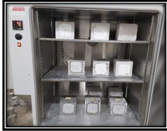
Resim 4.11 75 °C sıcaklıktaki etüvde bekletilen beton örnekleri
