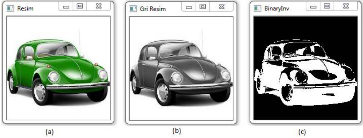
Şekil 5.21. Resmi matris olarak alma (a) orjinal resim, (b) gri resim, (c) BinaryInv tipinde eşikleme yapılmış resim
