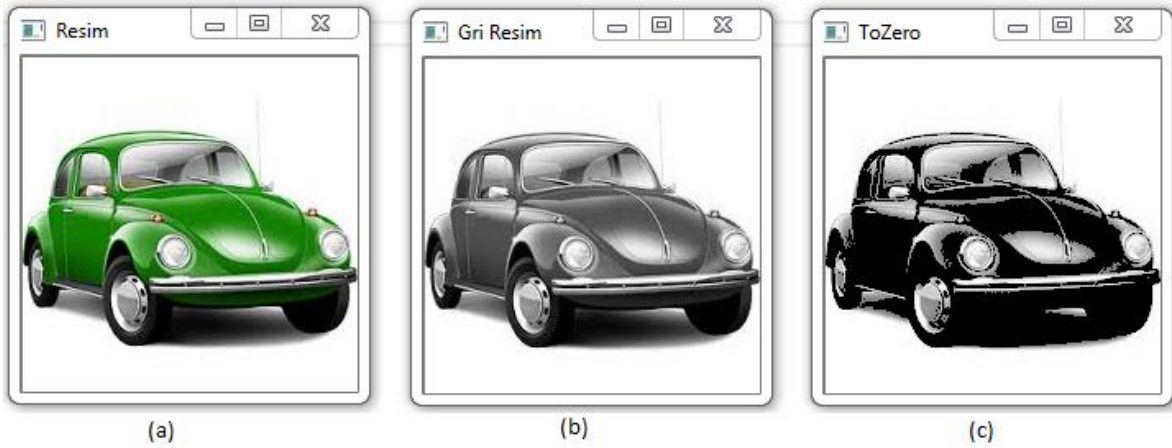
Şekil 5.22. Resmi matris olarak alma (a) orjinal resim, (b) gri resim, (c) ToZero tipinde eşikleme yapılmış resim
