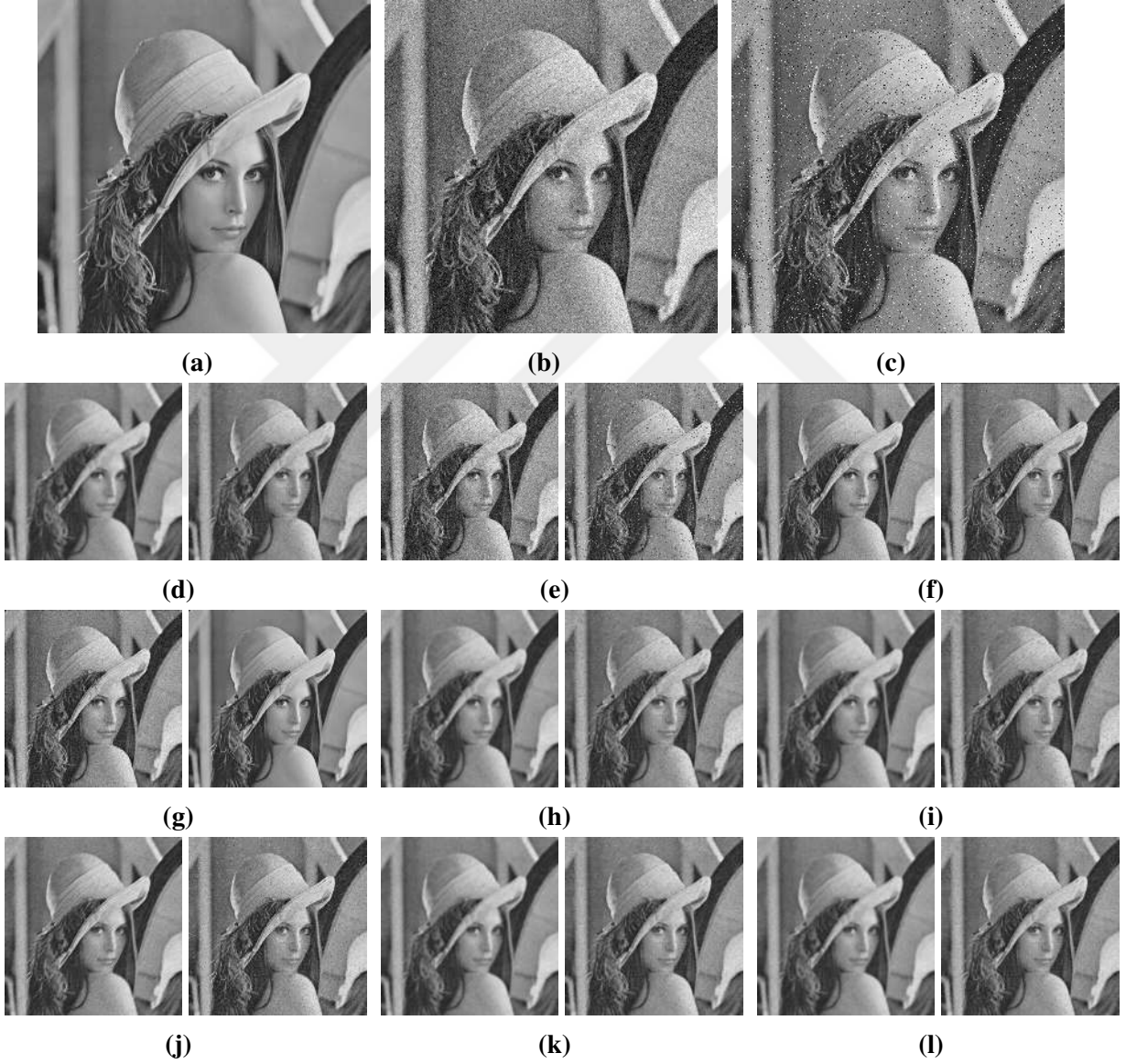
Şekil 4.4. Gauss (solda) ve Salt-Pepper (sağda) gürültü giderme sonuçları: (a) Orijinal, (b) Gauss gürültülü, (c) Salt-Pepper gürültülü; İzotropik filtreler: (d) Beltrami, (e) Gauss, (f) Mean, (g) Median; Anizotropik filtreler: (h) Yeni Randers, (i) Ingarden, (j) N. Miron, (k) Yeni N.Miron, (l) Yeni Metrik.
