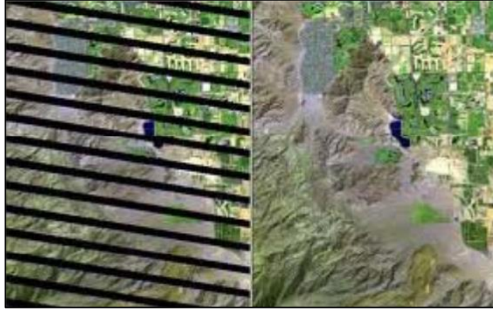
Şekil 4. De-striping hatası (URL-2).
