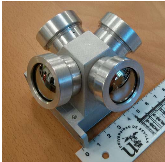
Detayları [18]'de verilen, alçak yörüngeli uydular için tasarlanan bir durağan ufuk sensörü fotoğrafı ise Şekil 3.15'te görülmektedir.
