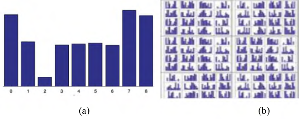
Şekil 14: Histogram blokları. (a) Tek bir hücre için örnek histogram (Mallick, 2016), (b) görüntüde kullanılan tüm hücreleri temsil eden toplam histogramların gösterimi (Dadi & Pillutla, 2016)
