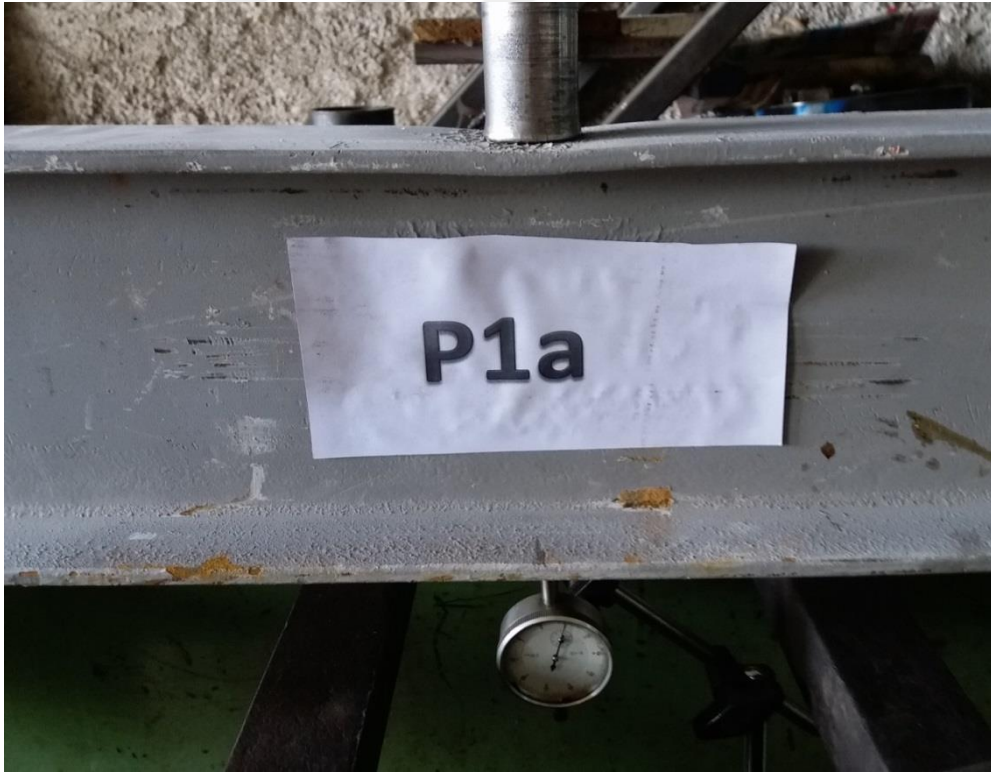
Şekil 4.34. 1.Grup P1a Numunesinin Eğilme Sonrası Durumu
