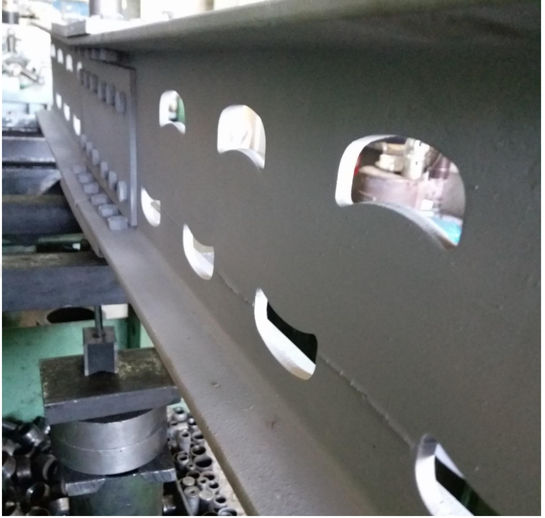
Şekil 4.79. 4.Grup P4b Numunesinin Eğilme Sonrası Durumu ve Burkulması
