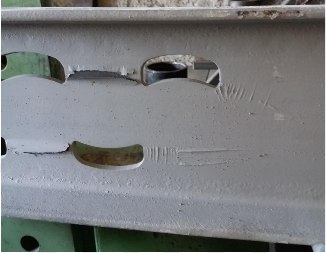
Şekil 4.84. 4.Grup P4c Numunesinin Eğilme Sonrası Durumu Açıklıkta
