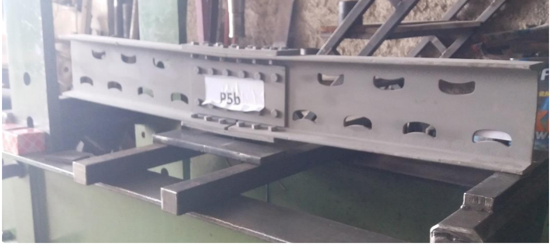
Şekil 4.92. 5.Grup P5b Numunesinin Başlangıç ve Eğilme Sonrası Durumu
