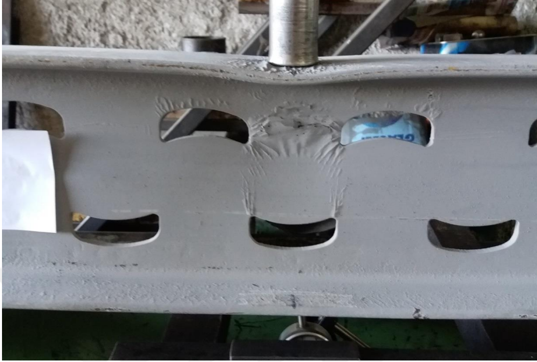
Şekil 4.73. 4.Grup P4a Numunesinin Eğilme Sonrası Durumu. Açıklıkta
