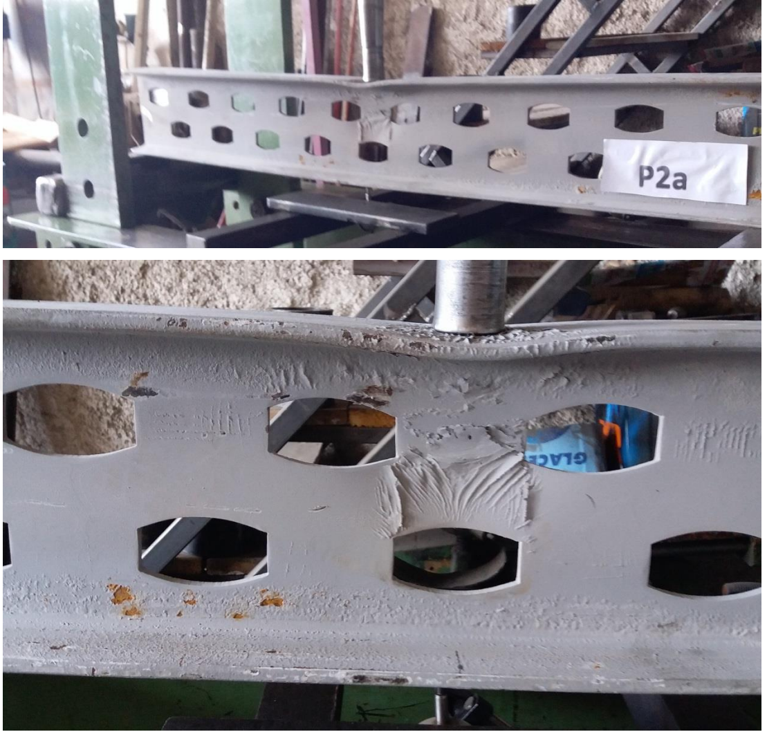
Şekil 4.43. 2.Grup P2a Numunesinin Eğilme Sonrası Durumu
