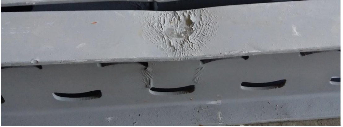
Şekil 4.75. 4.Grup P4a Numunesinin Eğilme Sonrası Durumu.
