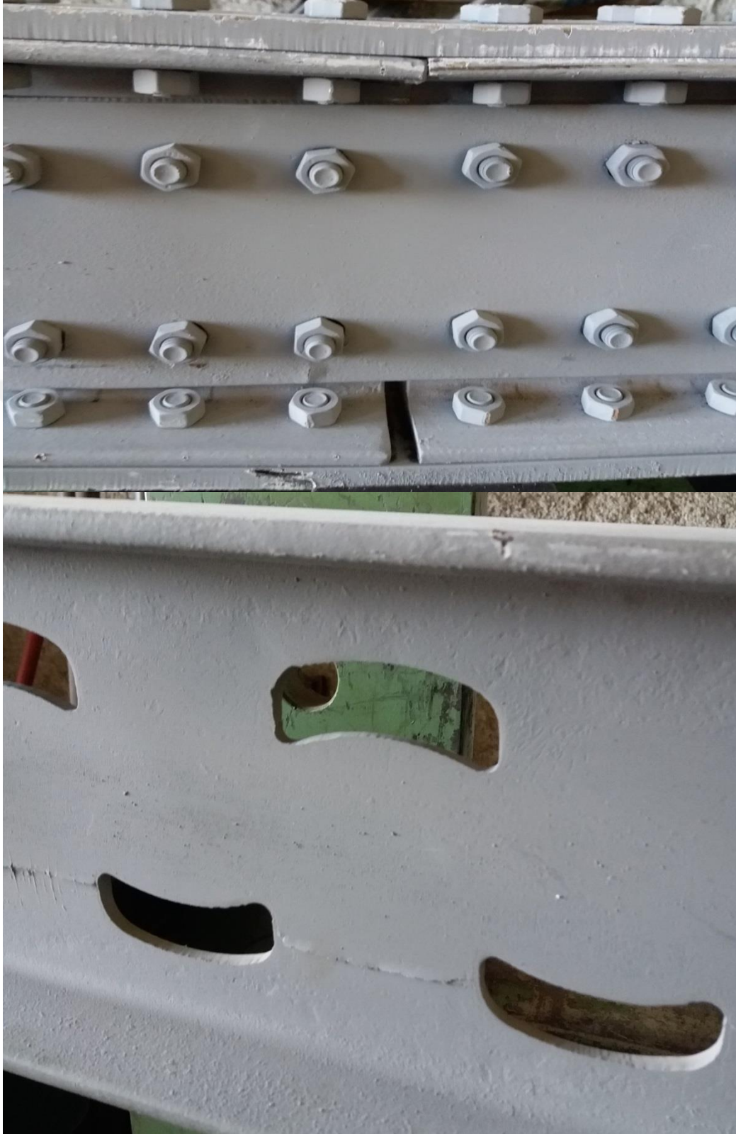
Şekil 4.78. 4.Grup P4a Numunesinin Eğilme Sonrası Durumu Açıklık ve Mesnette
