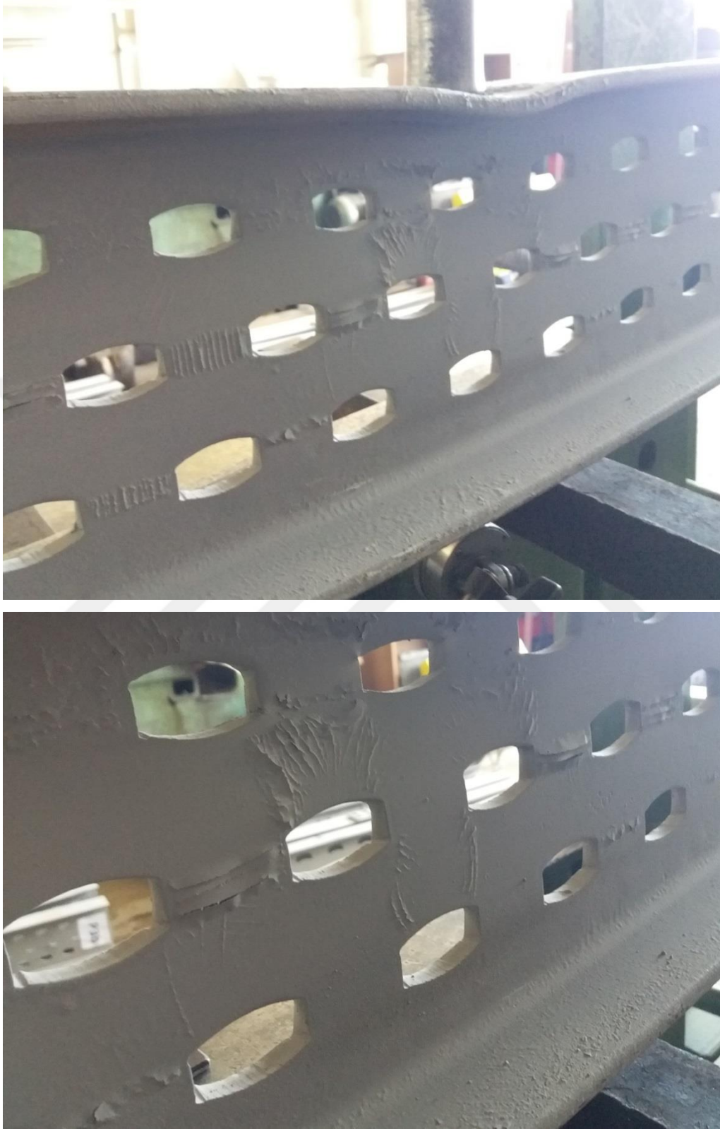
Şekil 4.58. 3.Grup P3a Numunesinin Eğilme Sonrası Durumu
