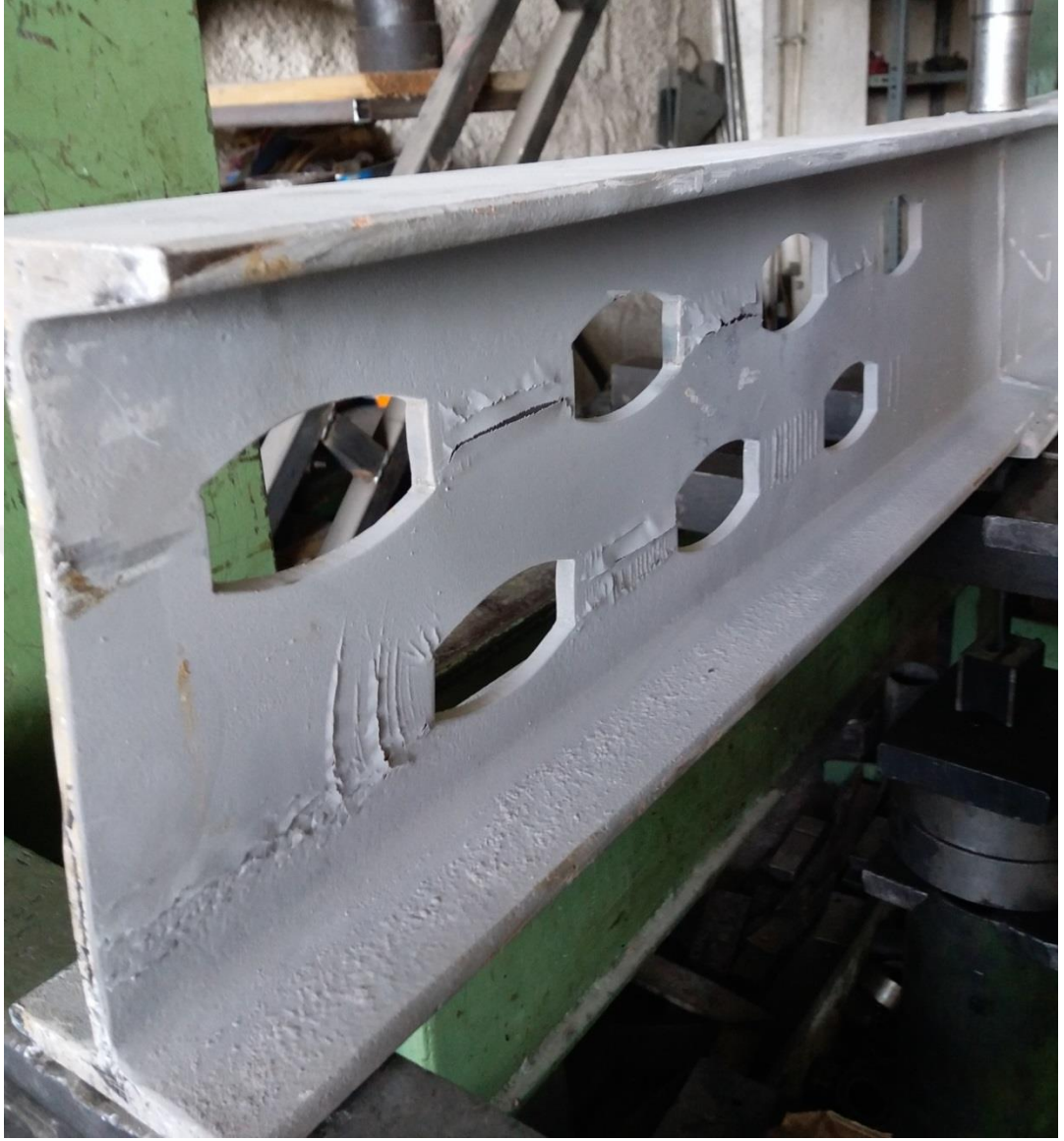
Şekil 4.50. 2.Grup P2c Numunesinin Eğilme Sonrası Durumu
