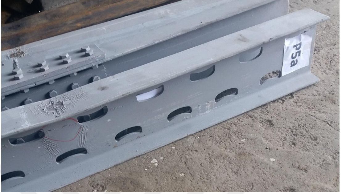
Şekil 4.90. 5.Grup P5a Numunesinin Eğilme Sonrası Durumu.
