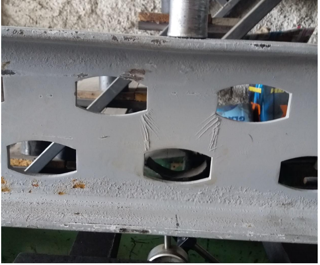
Şekil 4.41. 2. Grup P2a Numunesinin 5 mm Sehim Sonrası Durumu
