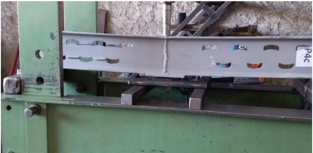
Şekil 4.83. 4.Grup P4c Numunesinin Eğilme Sonrası Durumu
