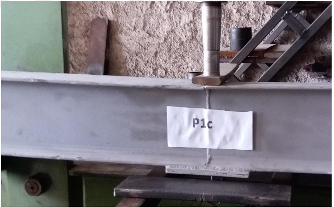
Şekil 4.37. 1.Grup P1c Numunesinin Başlangıç ve Eğilme Sonrası Durumu
