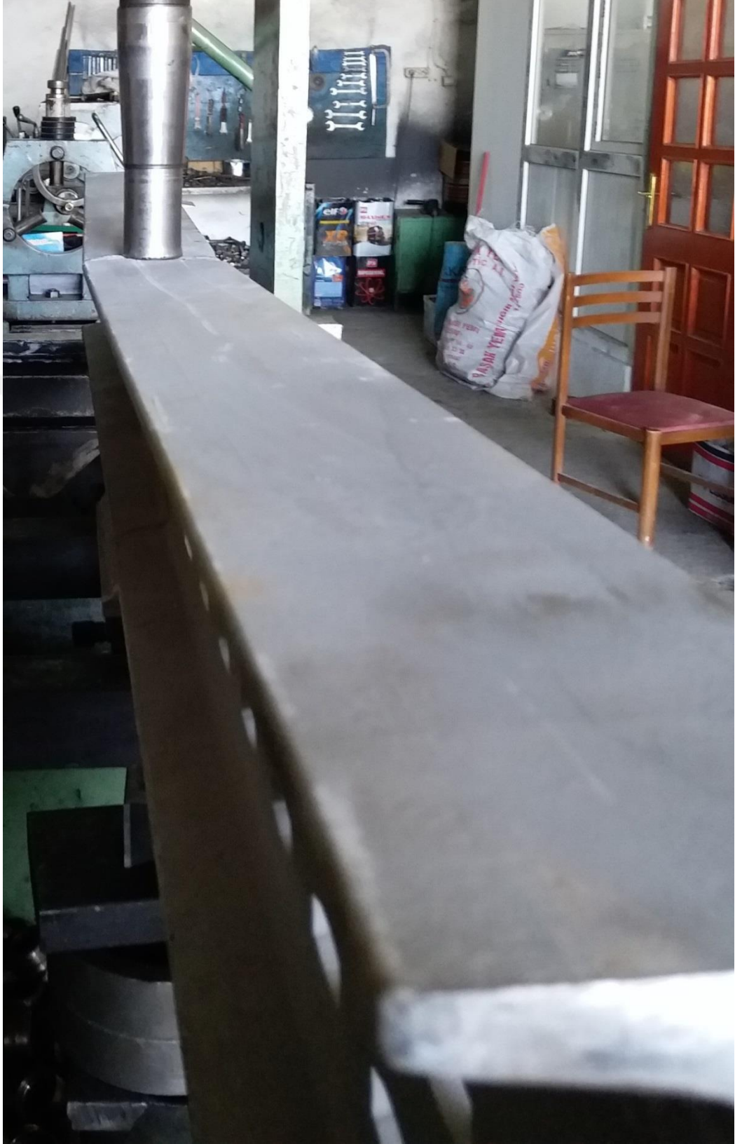
Şekil 4.67. 3.Grup P3c Numunesinin Eğilme Sonrası Durumu ve Burkulması
