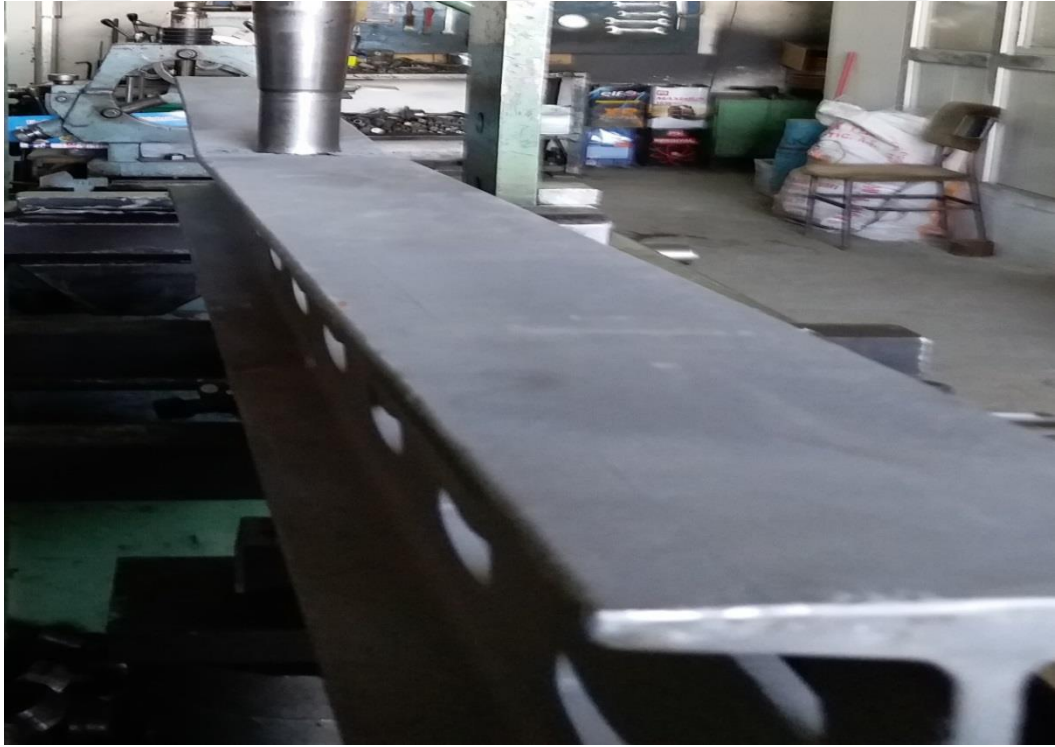
Şekil 4.74. 4.Grup P4a Numunesinin Eğilme Sonrası Durumu ve Burkulması
