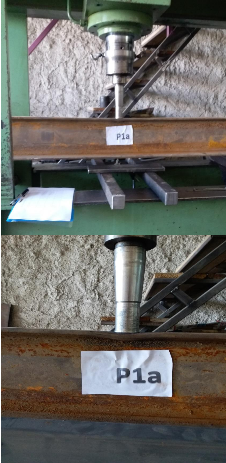
Şekil 4.29. 1.Grup P1a Numunesinin Eğilme Sonrası Durumu
