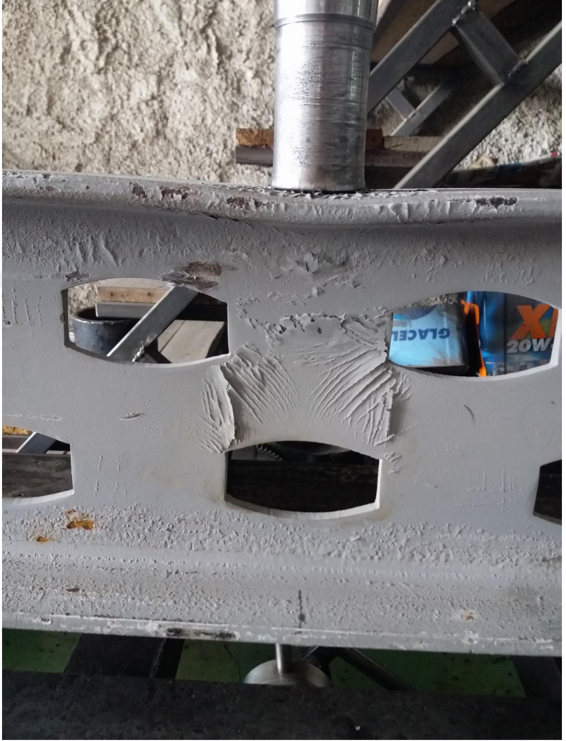
Şekil 4.42. 2.Grup P2a Numunesinin Eğilme Sonrası Durumu
