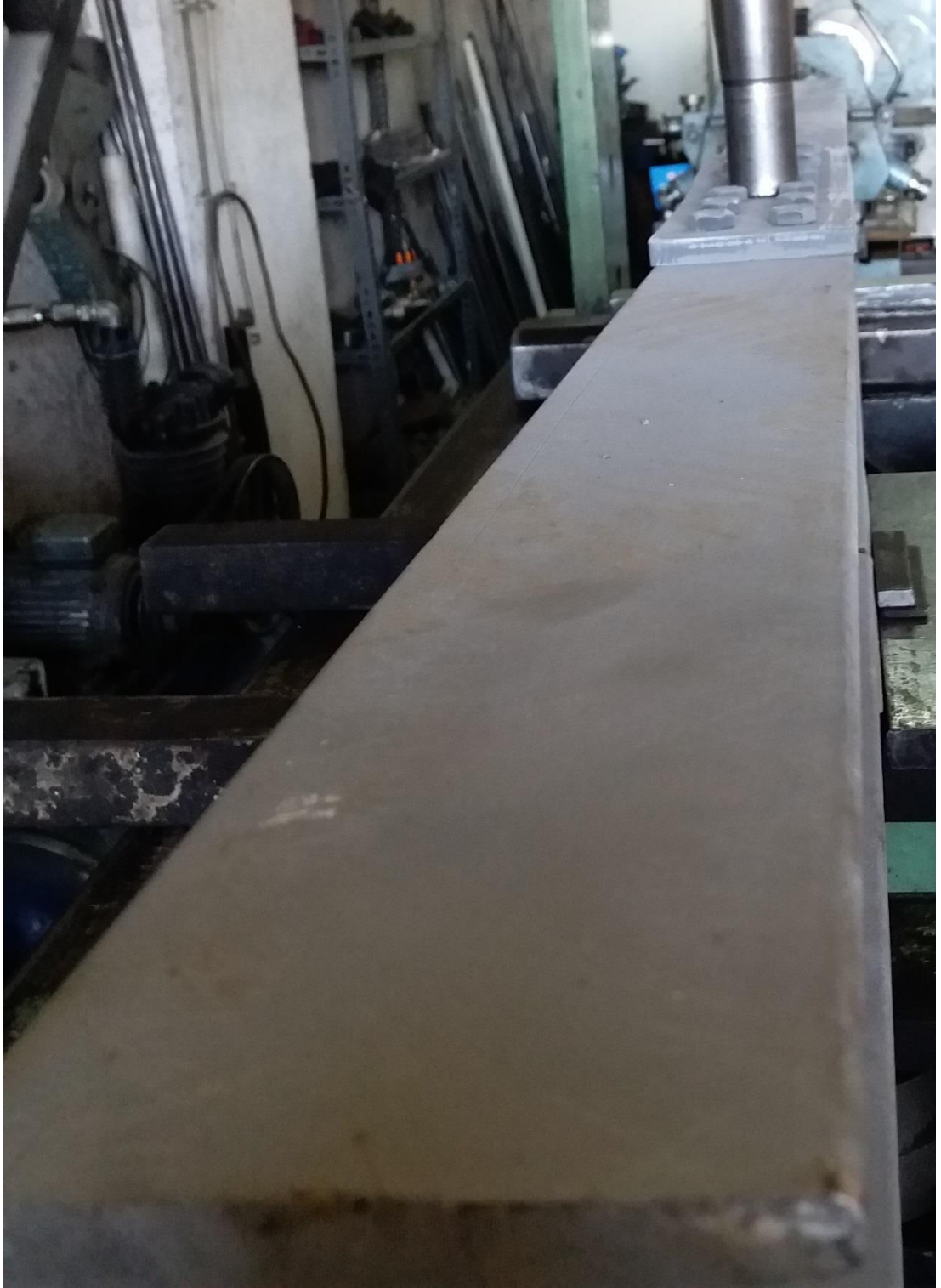
Şekil 4.63. 3.Grup P3b Numunesinin Eğilme Sonrası Durumu ve Burkulması
