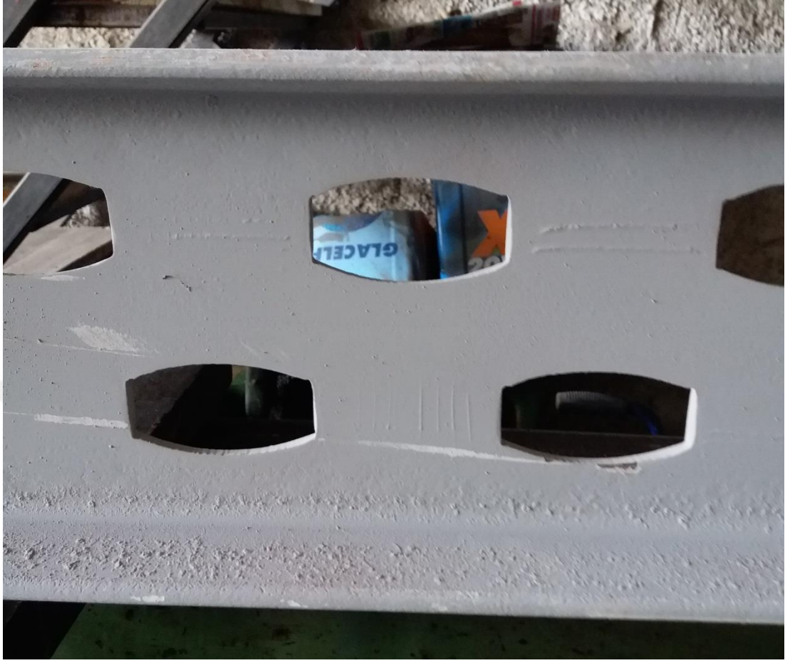
Şekil 4.49. 2.Grup P2c Numunesinin Başlangıç 5mm Sehim Sonrası Durumu
