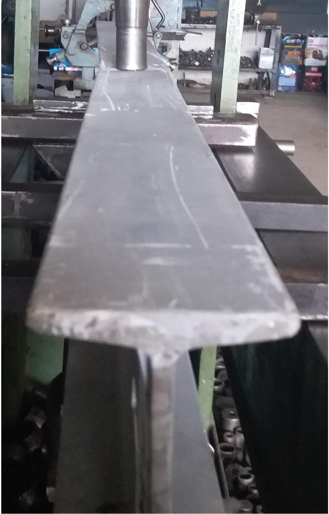
Şekil 4.95. 5.Grup P5c Numunesinin Eğilme Sonrası Durumu ve Burkulması
