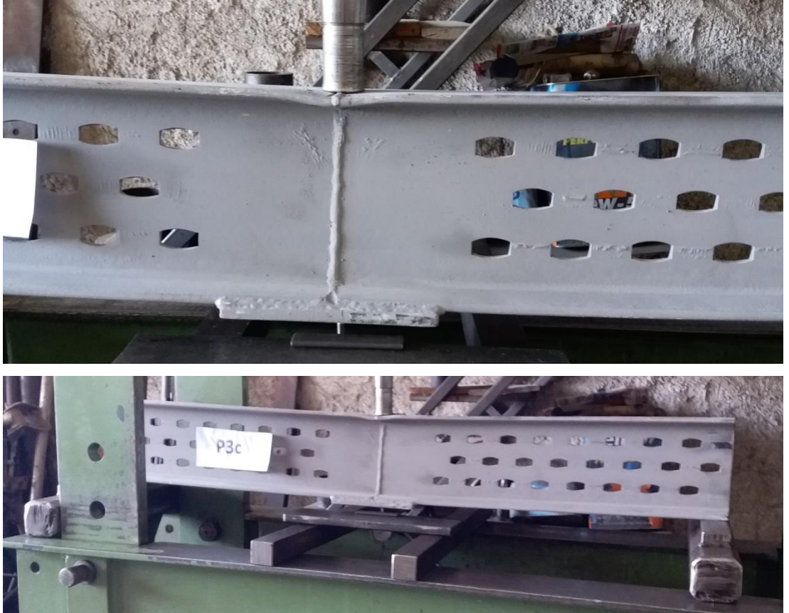
Şekil 4.65. 3.Grup P3c Numunesinin Eğilme Sonrası Durumu
