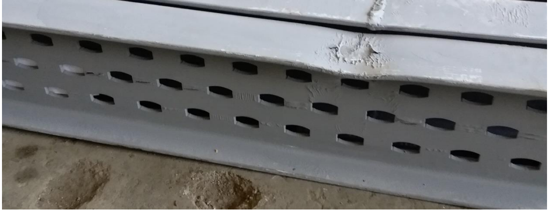
Şekil 4.59. 3.Grup P3a Numunesinin Eğilme Sonrası Durumu
