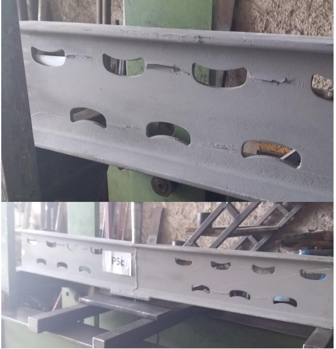
Şekil 4.94. 5.Grup P5c Numunesinin Eğilme Sonrası Durumu Mesnette ve Açıklıkta
