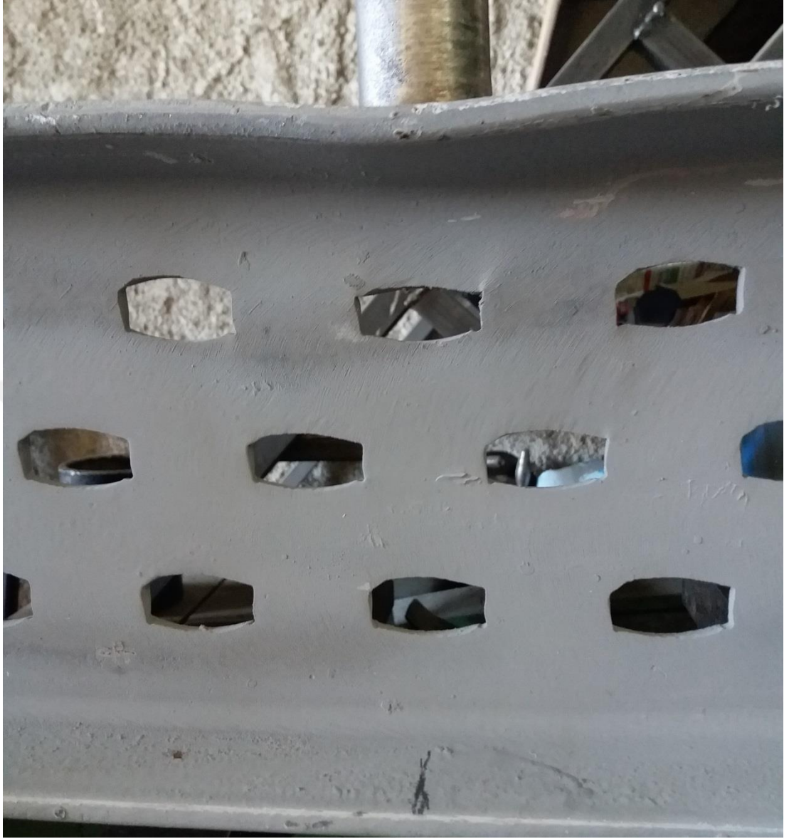
Şekil 4.57. 3.Grup P3a Numunesinin 5mm SehimSonrası Durumu
