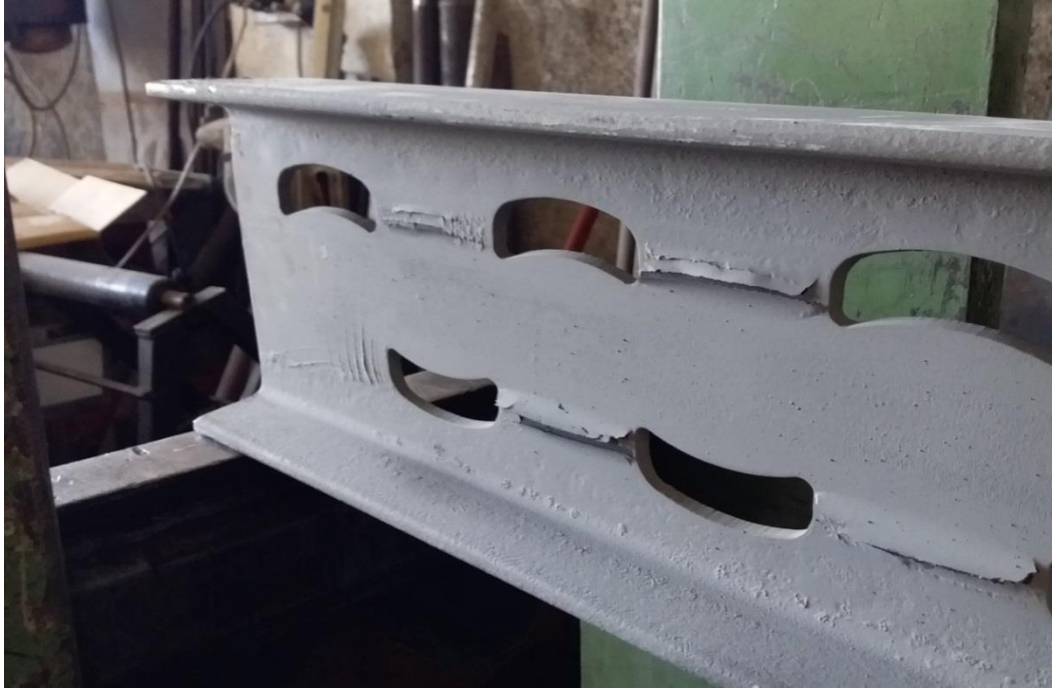
Şekil 4.85. 4.Grup P4c Numunesinin Eğilme Sonrası Durumu Mesnette
