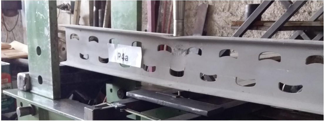
Şekil 4.72. 4.Grup P4a Numunesinin Eğilme Sonrası Durumu. Mesnette
