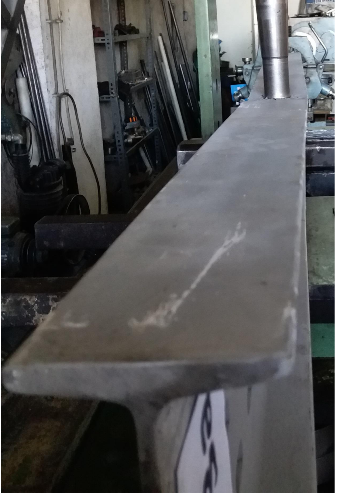
Şekil 4.56. 3.Grup P3a Numunesinin 5mm Sehim Sonrası Durumu
