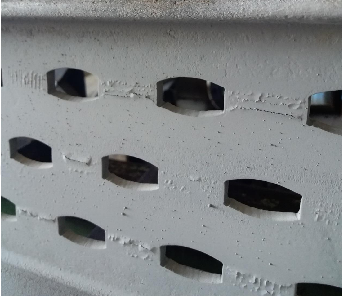
Şekil 4.69. 3.Grup P3c Numunesinin Eğilme Sonrası Durumu
