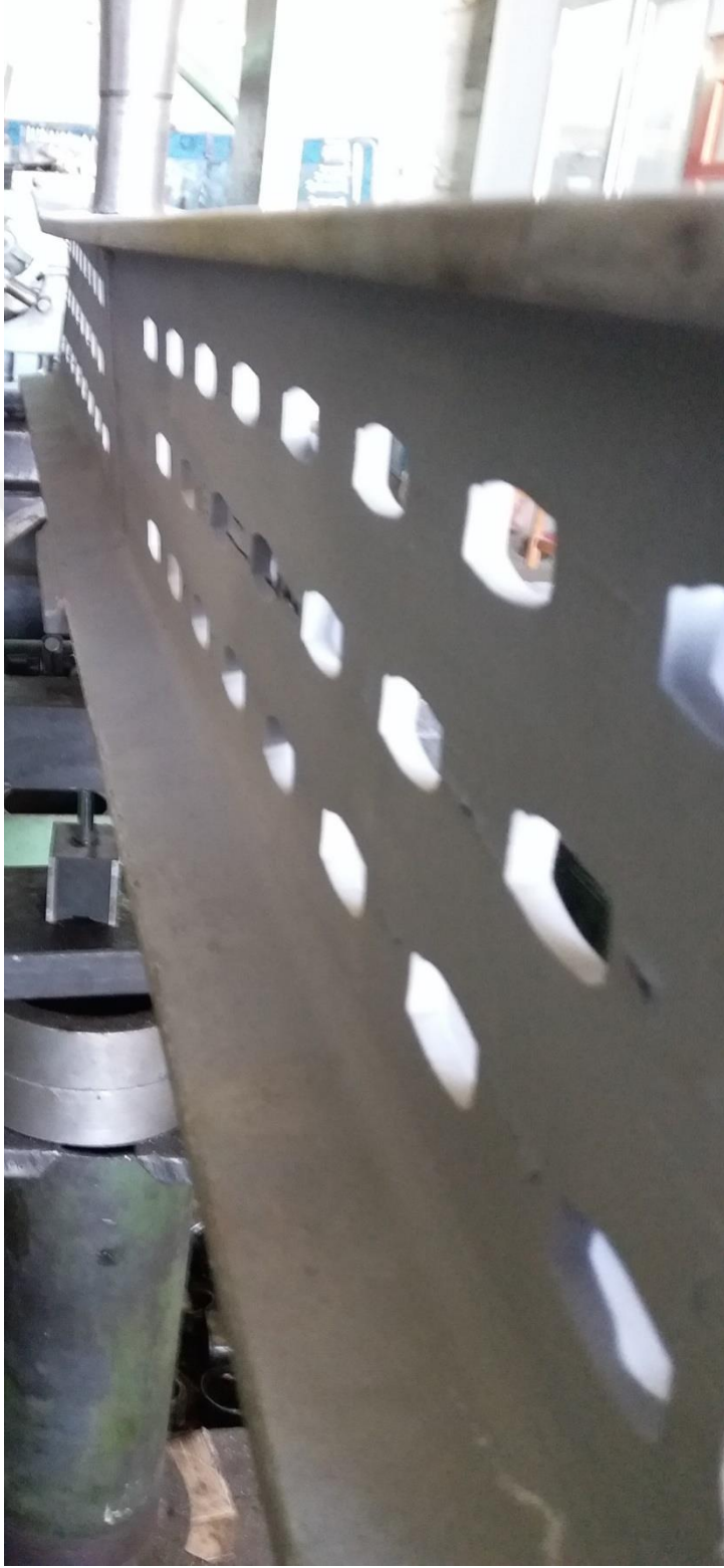
Şekil 4.68. 3.Grup P3c Numunesinin Eğilme Sonrası Durumu ve Burkulması
