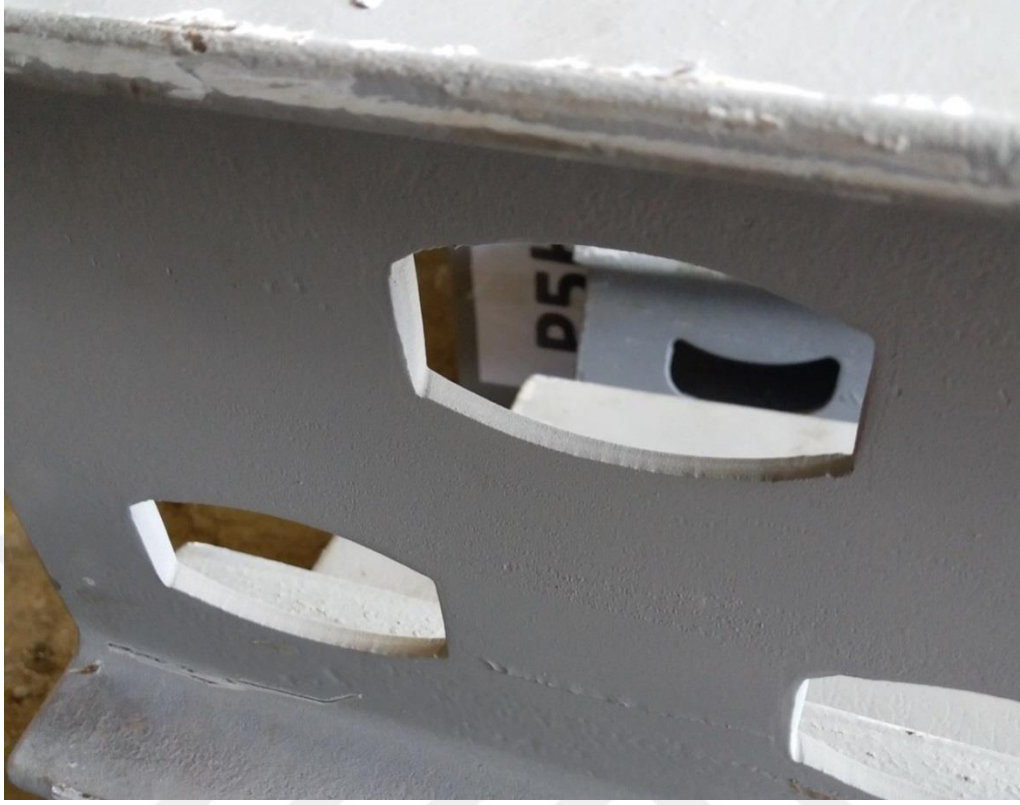
Şekil 4.48. 2.Grup P2b Numunesinin Eğilme Sonrası Durumu Mesnet Bölgesi
