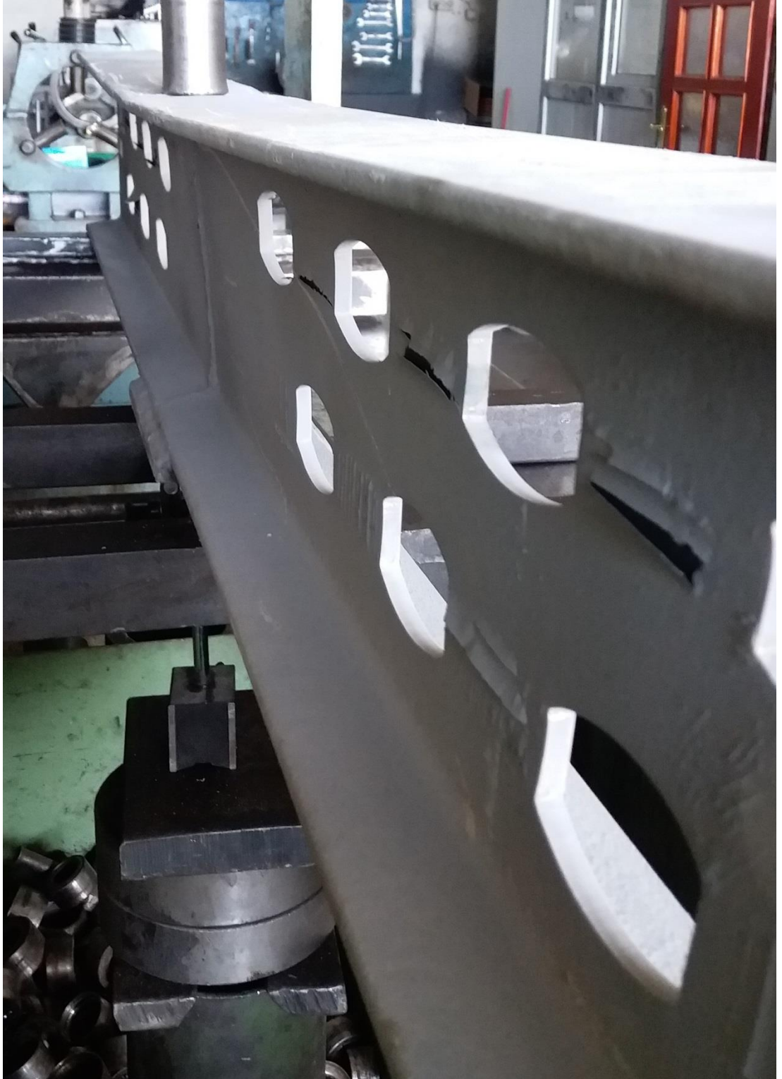
Şekil 4.52. 2.Grup P2c Numunesinin Eğilme Sonrası Durumu ve Burkulması
