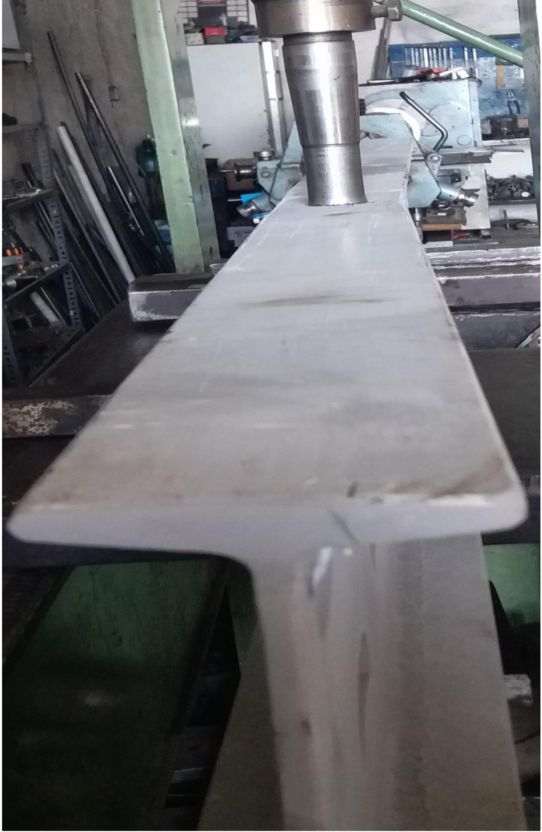
Şekil 4.91. 5.Grup P5a Numunesinin Eğilme Sonrası Durumu ve Burkulması
