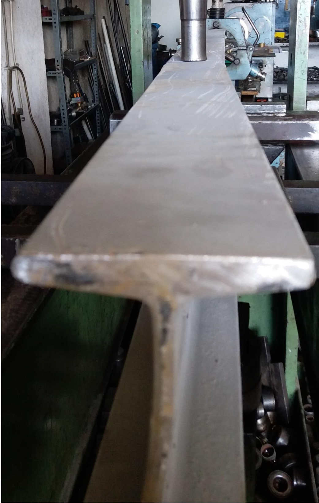
Şekil 4.51. 2.Grup P2c Numunesinin Eğilme Sonrası Durumu ve Burkulması
