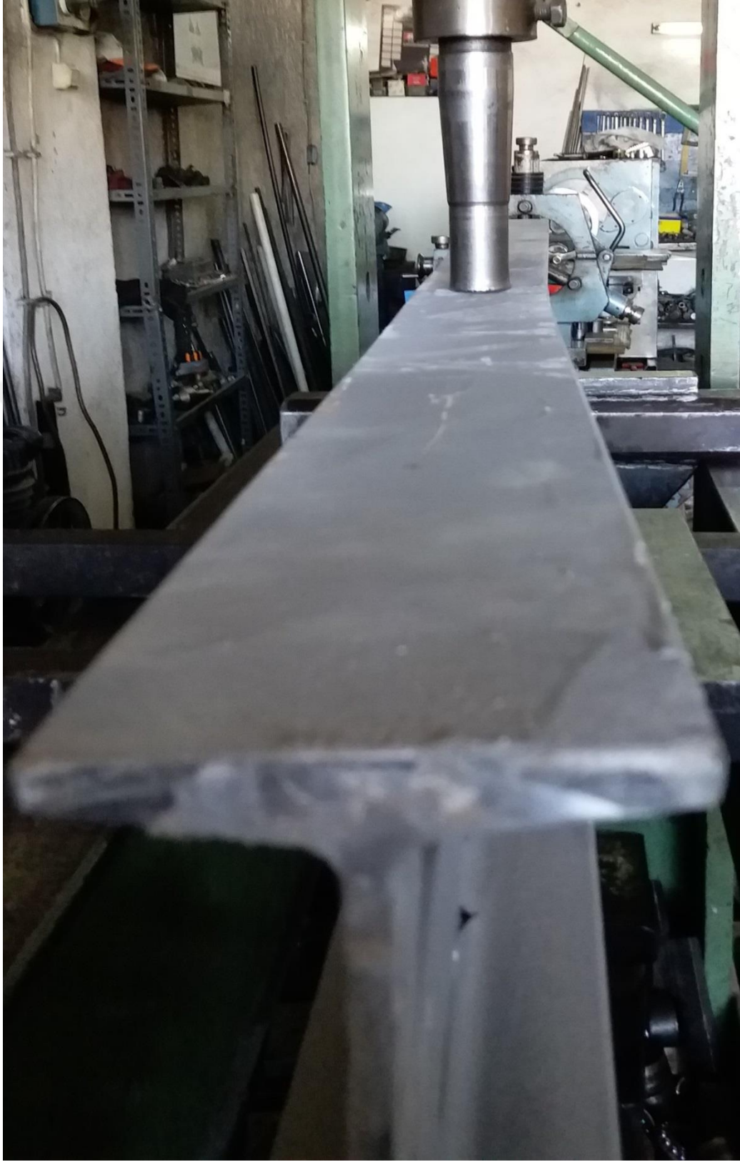
Şekil 4.86. 4.Grup P4c Numunesinin Eğilme Sonrası Durumu ve Burkulması
