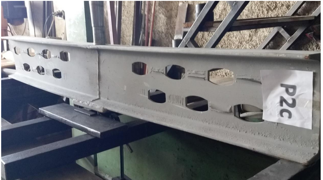
Şekil 4.54. 2.Grup P2c Numunesinin Eğilme Sonrası Durumu
