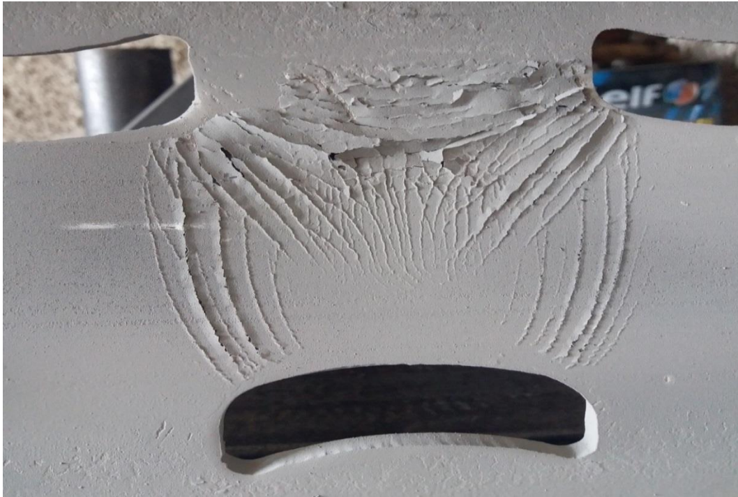
Şekil 4.89. 5.Grup P5a Numunesinin Eğilme Sonrası Durumu.
