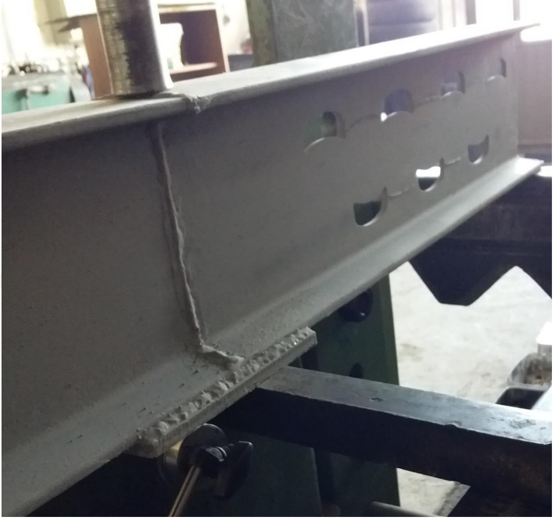
Şekil 4.82. 4.Grup P4c Numunesinin Eğilme Sonrası Durumu Mesnette
