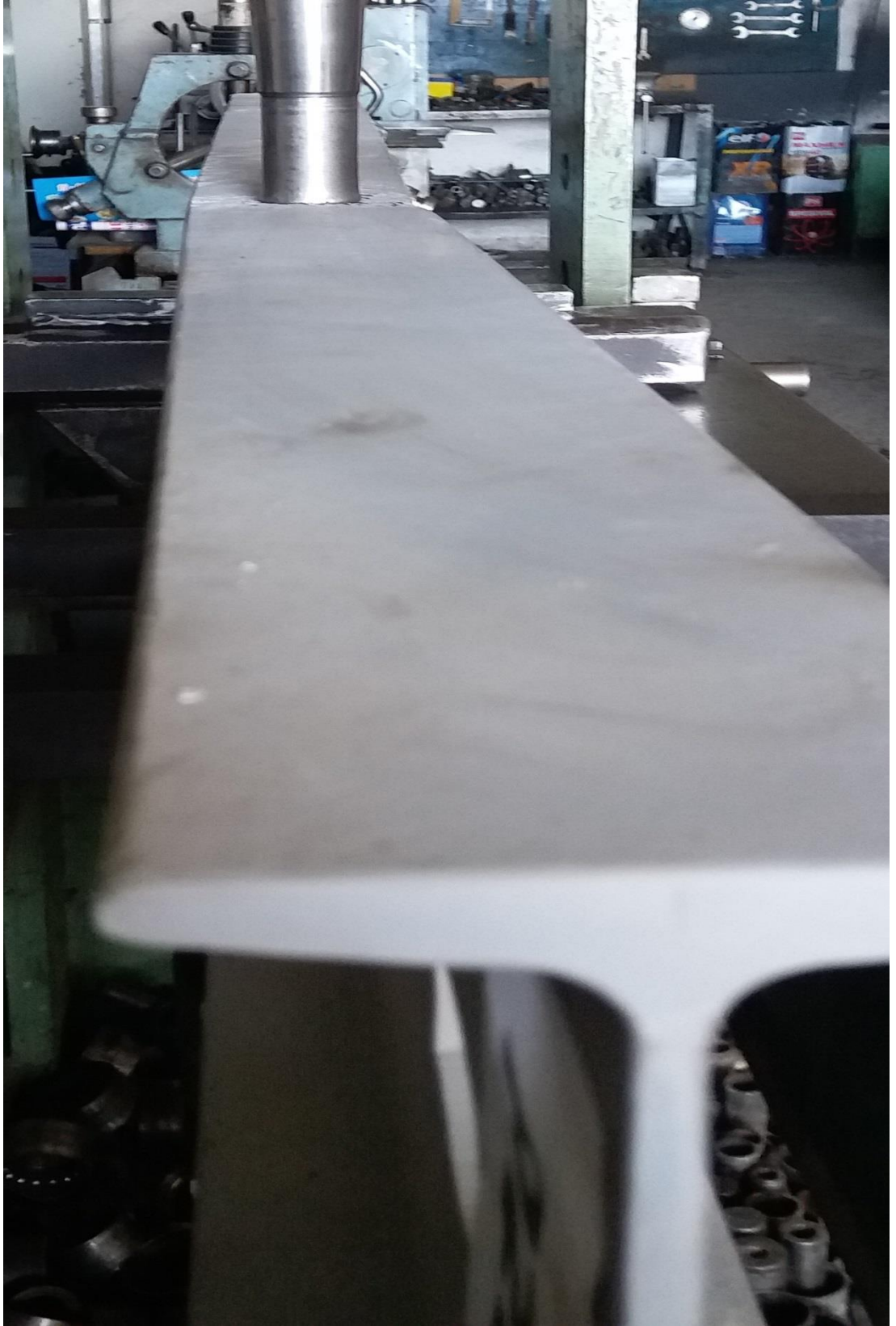
Şekil 4.44. 2.Grup P2a Numunesinin Eğilme Sonrası Durumu ve Burkulması
