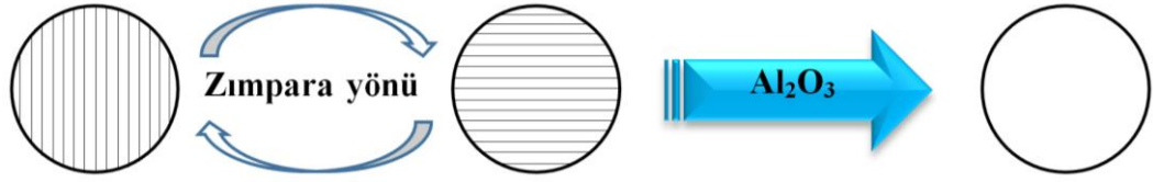
Şekil 4.3. Doğru zımpara işlemi şematiği
