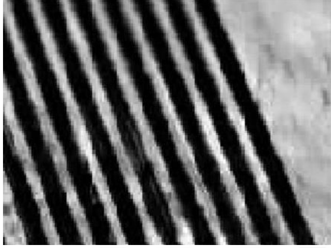
Şekil 2.16. Saf bakır iş parçası üzerinde biyo-işlenmiş olukların SEM görüntüsü (80 mikron derinlik ve 45 mikron genişlik) (Chang et al. 2008)
