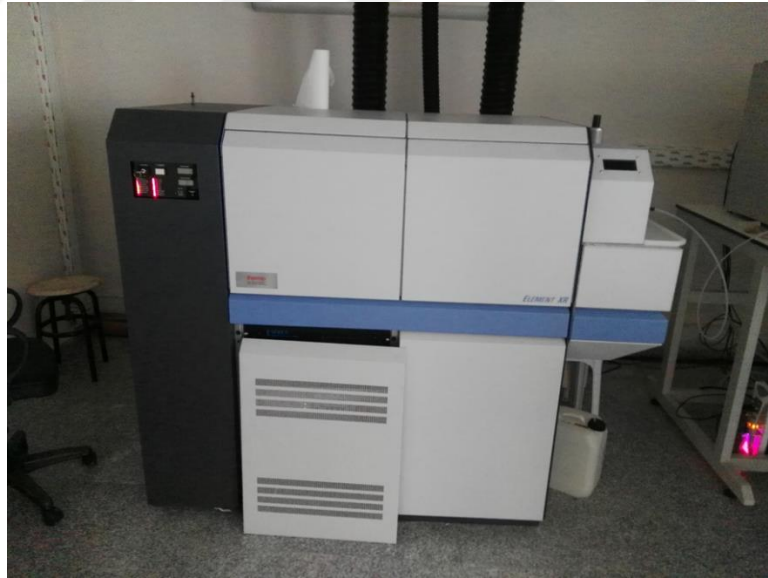
Şekil 3.8. Ankara Üniversitesi (YEBİM) Laboratuvarında bulunan Element™ Series HR-ICP-MS cihazı
