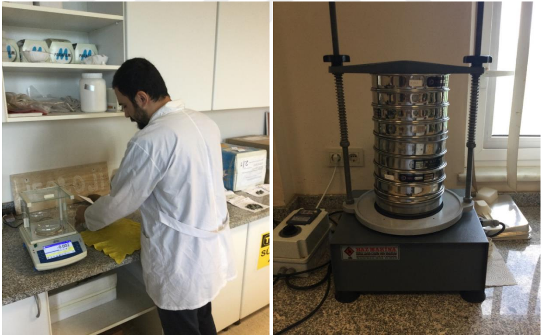
Şekil 3.4. Elek analiz için örneklerin hazırlaması
