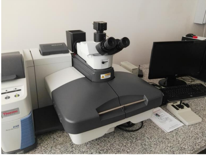
Şekil 3.7. İnce kesitlerin mikroskop altında petrografik amaçlı incelenmesi
